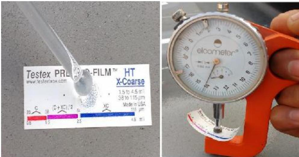
Figura 8. Cinta replica y medidor de rugosidad. (Mitma D., Mera G. y Vela A., 2019).
