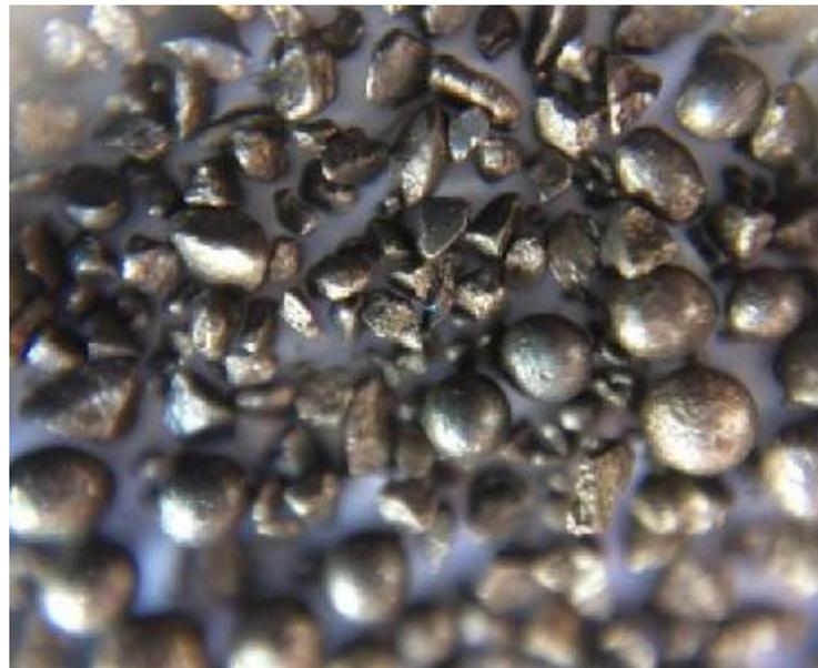
Figura 28. Acercamiento visual de la muestra de granalla extraída.
