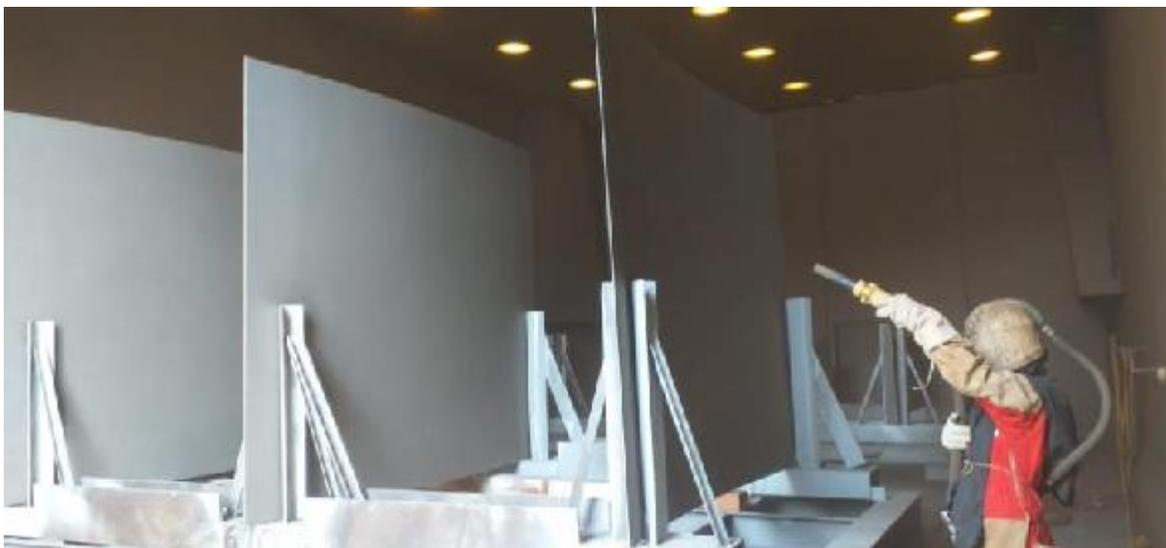
*Figura 26. Proceso de granallado de las planchas de acero al carbono A36.*
