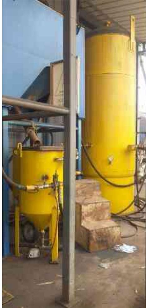
Figura 19. Tolva de granallado y compresora de aire.
