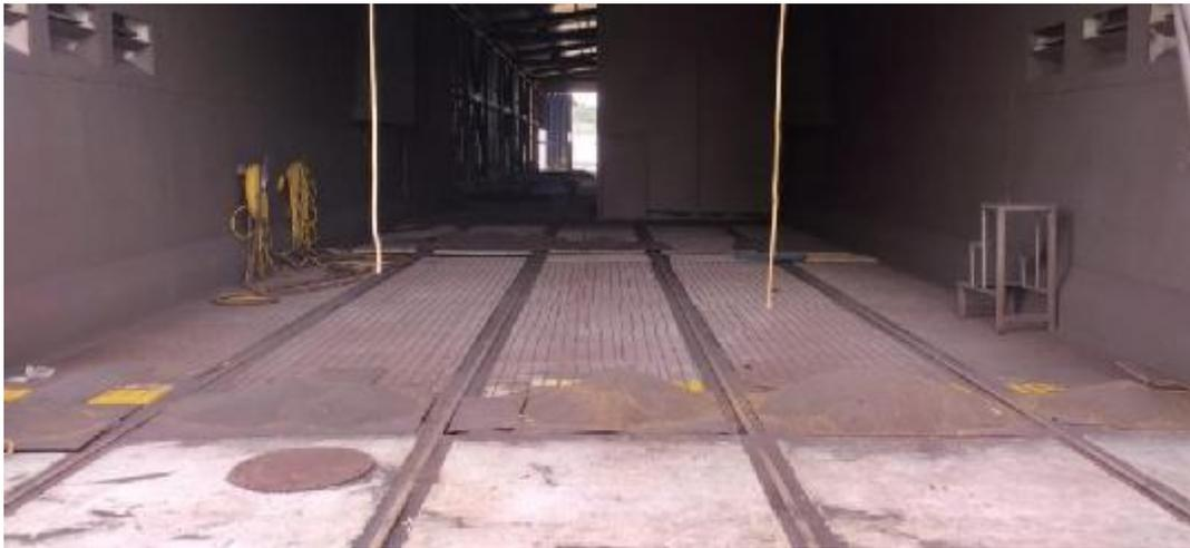
*Figura 21. Retiro de la granalla manualmente para realizar mantenimiento al recolector central y el sinfín transversal.*
