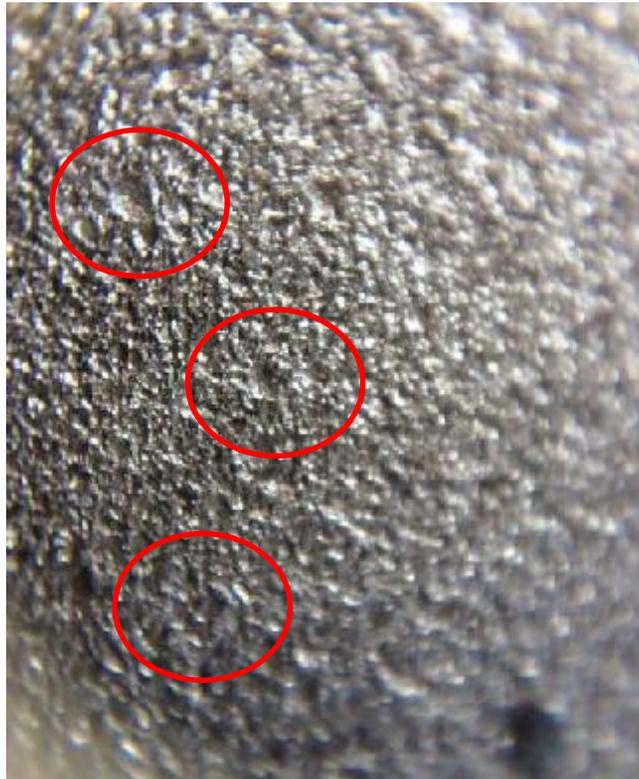
Figura 29. Acercamiento visual del área granallada donde se evidencia excesiva rugosidad generada por la granalla esférica.
