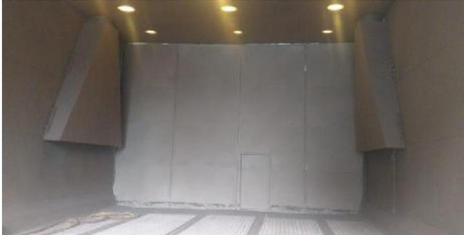
Figura 24. Recolector de polvo izquierdo y derecho en el interior de la cabina de granallado.
