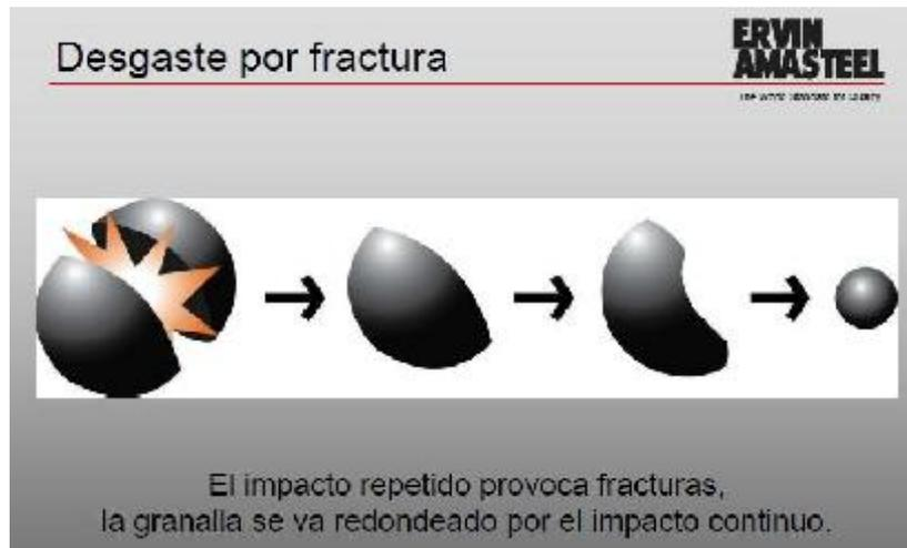
Figura 32. Reducción de la granalla al fracturarse al impactar. (Blasting Experts Ltda., 2020).
