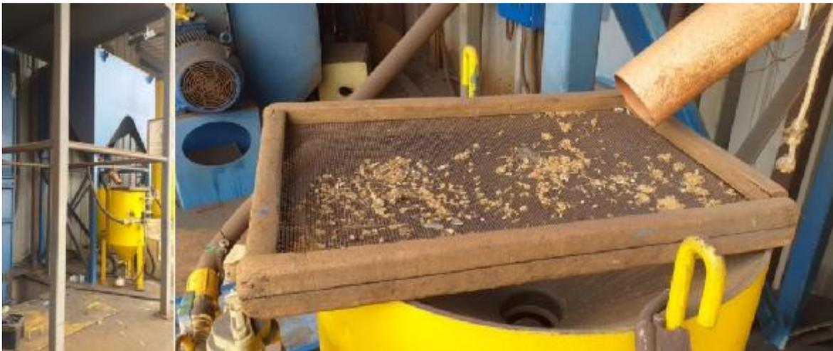
Figura 23. La noria abastece la tolva superior (azul) y esta abastece a la tolva de granallado (amarilla) para continuar con el ciclo del proceso de granallado.
