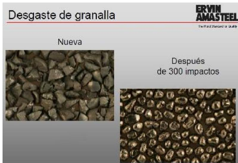
Figura 33. Acercamiento visual de antes y después del abrasivo desgastado. (Blasting Experts Ltda., 2020).
