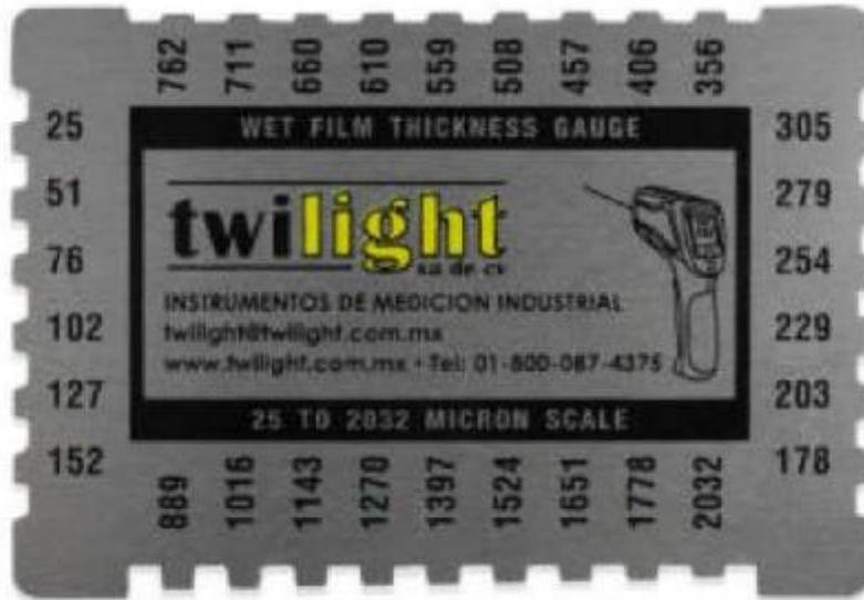
Figura 15. Medidor de película húmeda. (Berroa E., 2019).
