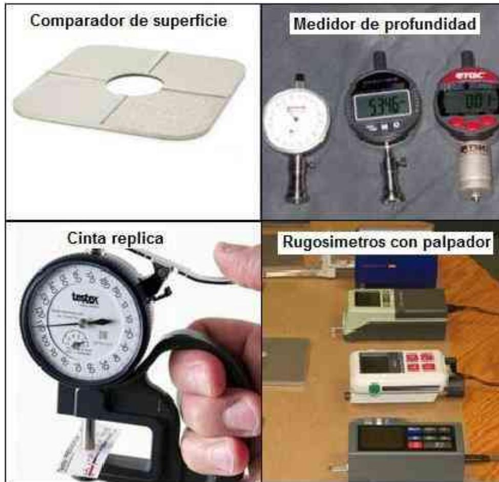
Figura 7. Métodos de medición de rugosidad. (Mitma D., Mera G. y Vela A., 2019).
