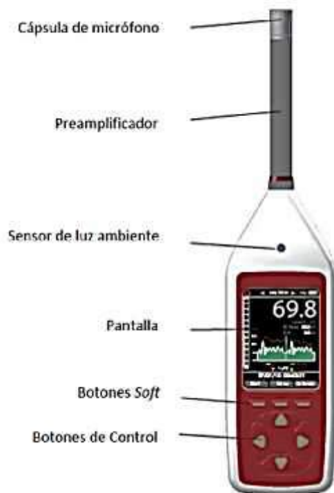
Figura 1. Componentes de un sonómetro
