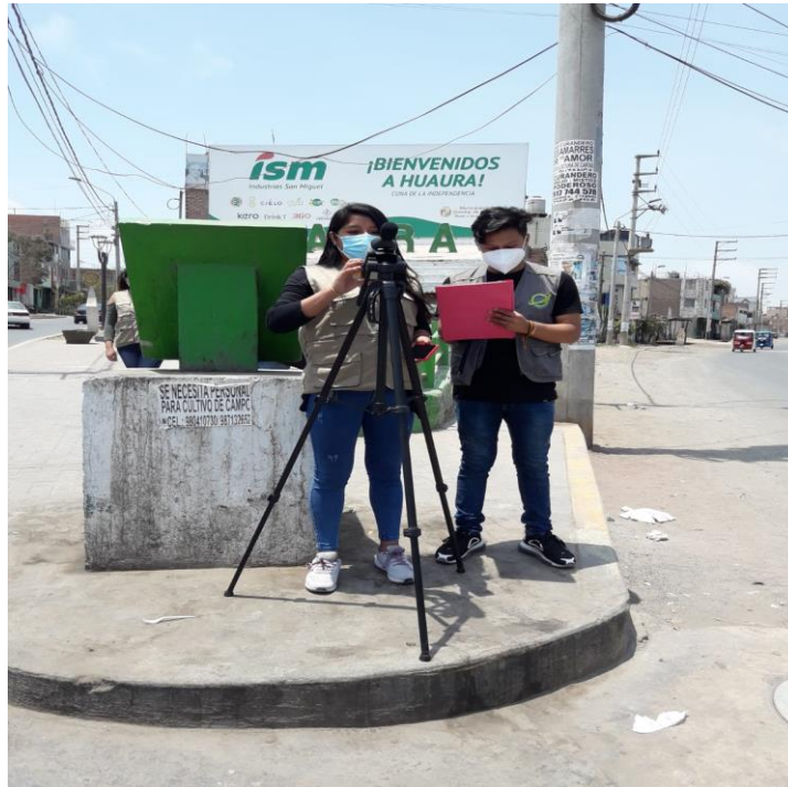
Figura 46. Instalación inicial del equipo de Monitoreo de Ruido
