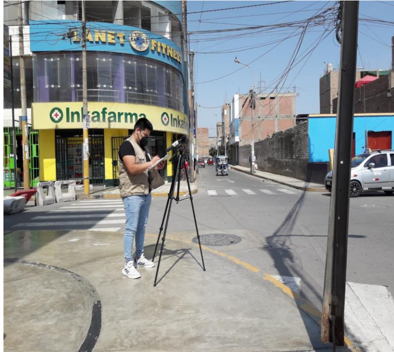
Figura 50. Medición del ruido realizado en la Intersección de Av. Buenos Aires /Los Libertadores
