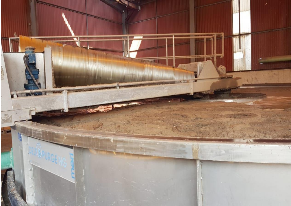
Figura 15. Funcionamiento del tanque de flotación Daf-Meri.
