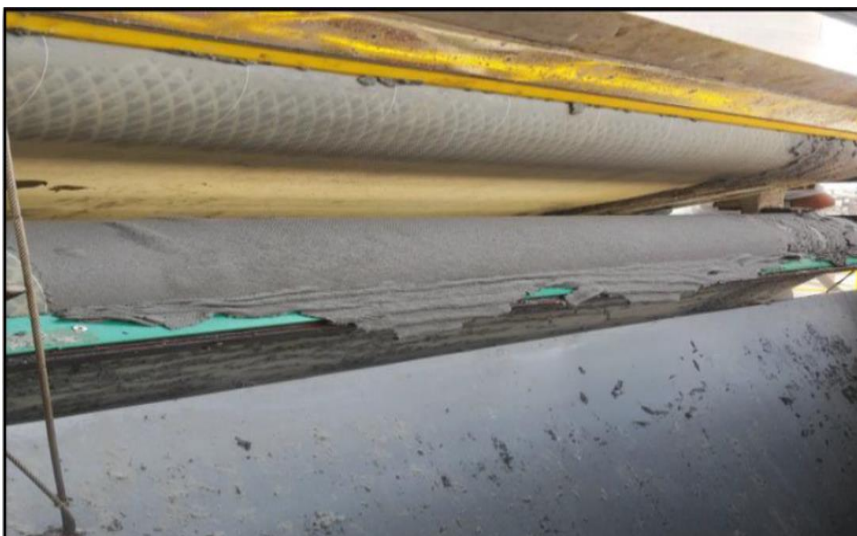
Figura 22. Formación torta en el Filtro prensa.
