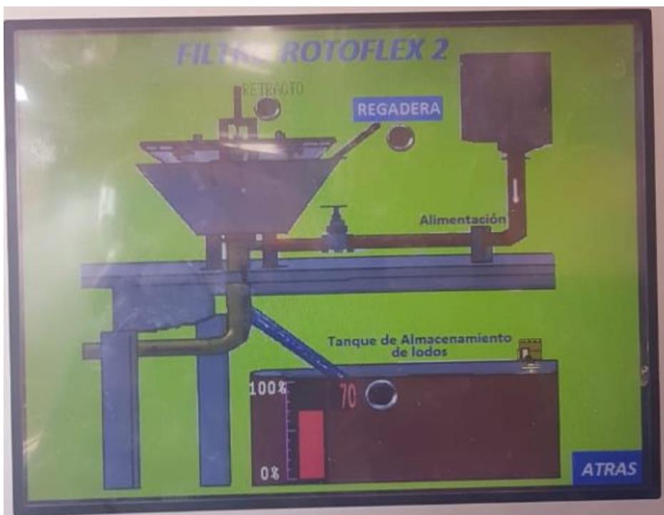
Figura 24. Control automático del filtro Rotoflex 2.
