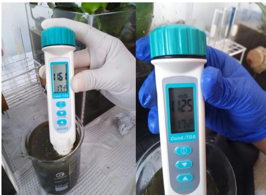
Figura 24: El sistema 1 y sistema 2, presenta una conductividad de 11.61mS y 11.25mS respectivamente. Esta medición se realizó a inicios de tratamiento.
