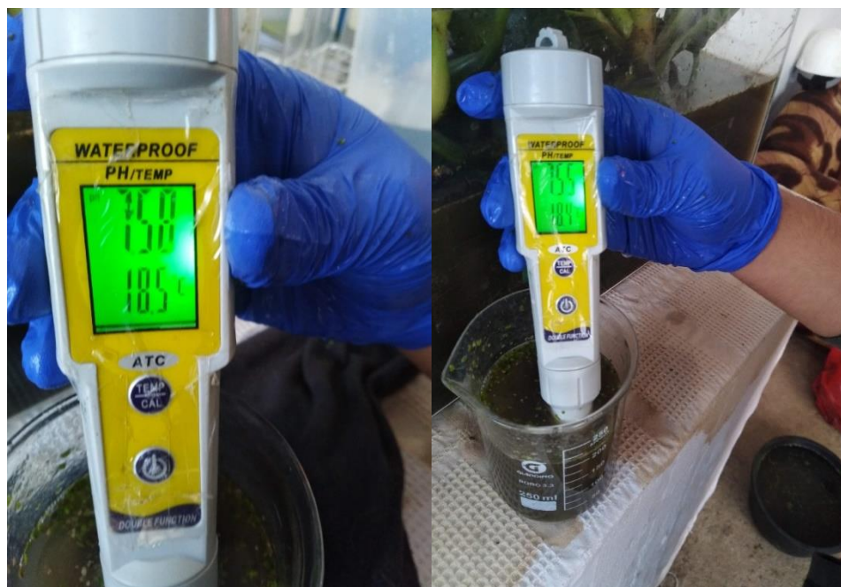
Figura 23: El sistema 1 y sistema 2, presenta un pH de 7.58 y 7.55 respectivamente en la cuarta muestra. En conclusión, el pH disminuyó 0.52 en ambos sistemas.
