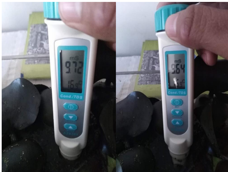
Figura 27: El sistema 1 y sistema 2, presenta una conductividad de 9.72mS y 9.64mS respectivamente en la cuarta muestra. La disminución de la conductividad eléctrica se dio considerablemente y tuvo una disminución de 1.89 en el sistema 1 y 1.61 en el sistema 2
