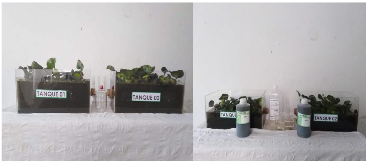
Figura 7: Toma de la segunda muestra del agua residual tratada con la planta
