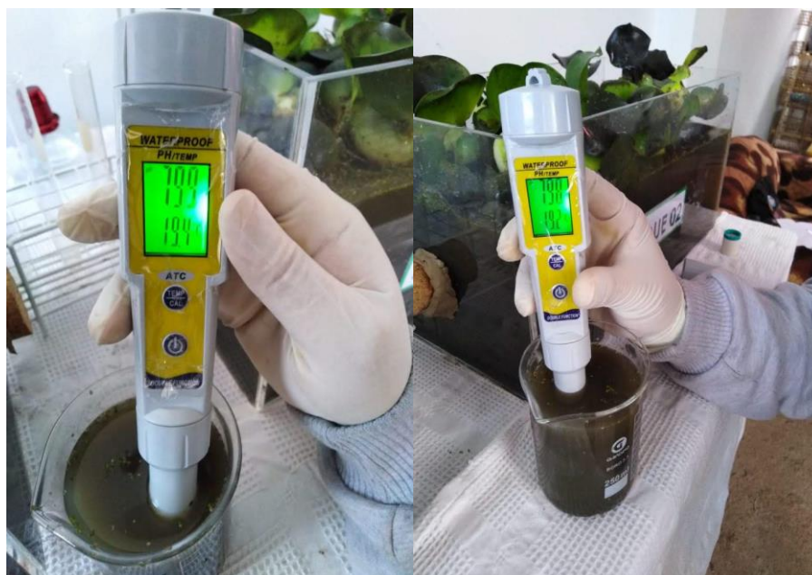
Figura 21: El sistema 1 y sistema 2, presenta un pH de 7.99 y 7.98 respectivamente en la segunda muestra. Cabe resaltar que el Ph tiende a disminuir.
