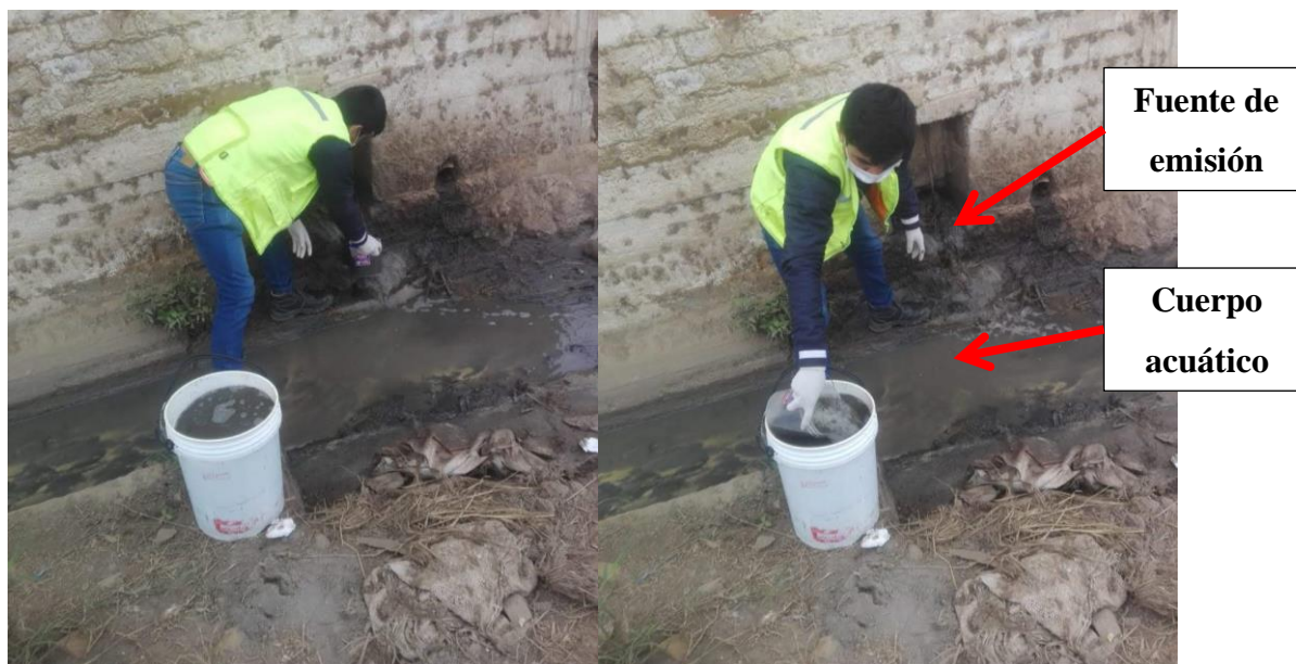
Figura 2: Toma de muestra del agua residual del punto inicial de vertimiento de la empresa CAMPOY S.R.L.
