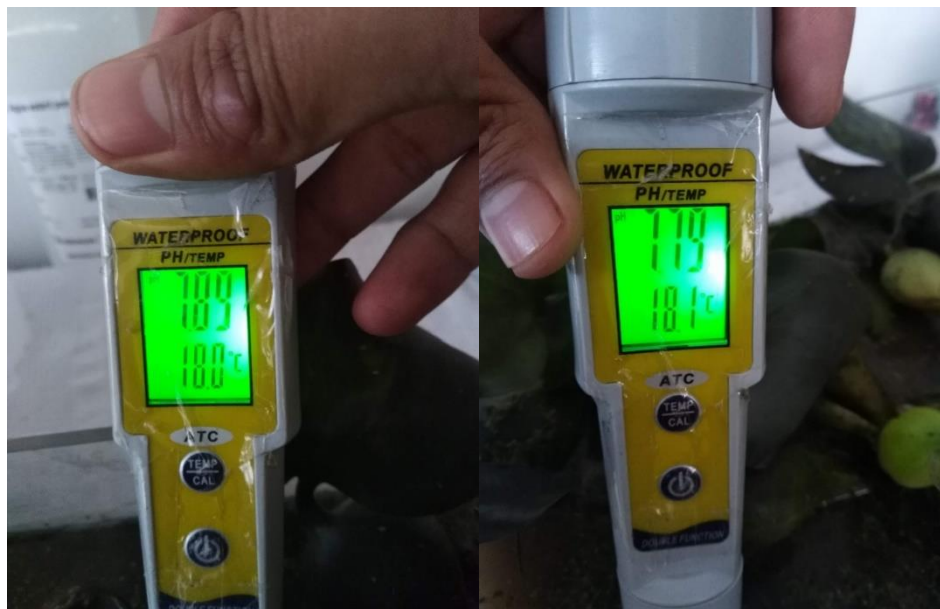
Figura 22: El sistema 1 y sistema 2, presenta un pH de 7.89 y 7.79 respectivamente en la tercera muestra. Cabe resaltar que el Ph ha disminuido notoriamente.
