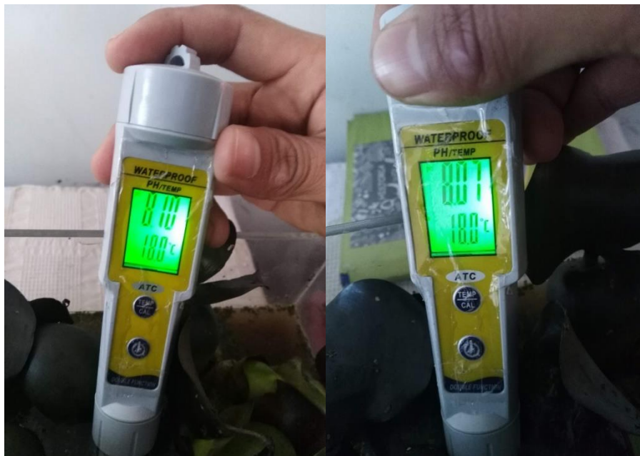
Figura 20: El sistema 1 y el sistema 2, presenta un pH de 8.10 y 8.07 respectivamente a inicios del tratamiento de aguas.
