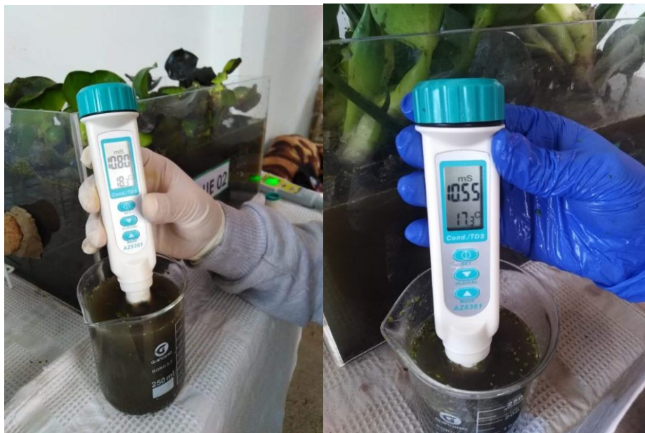
Figura 26: El sistema 1 y sistema 2, presenta una conductividad de 10.80mS y 10.55mS respectivamente en la tercera muestra. La disminución de la conductividad cada vez es más notoria.
