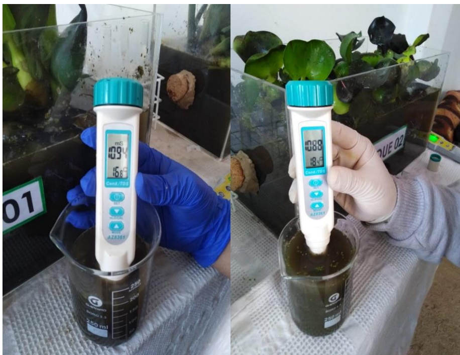
Figura 25: El sistema 1 y sistema 2, presenta una conductividad de 10.94mS y 10.88mS respectivamente en la segunda muestra. La conductividad eléctrica ha disminuido.
