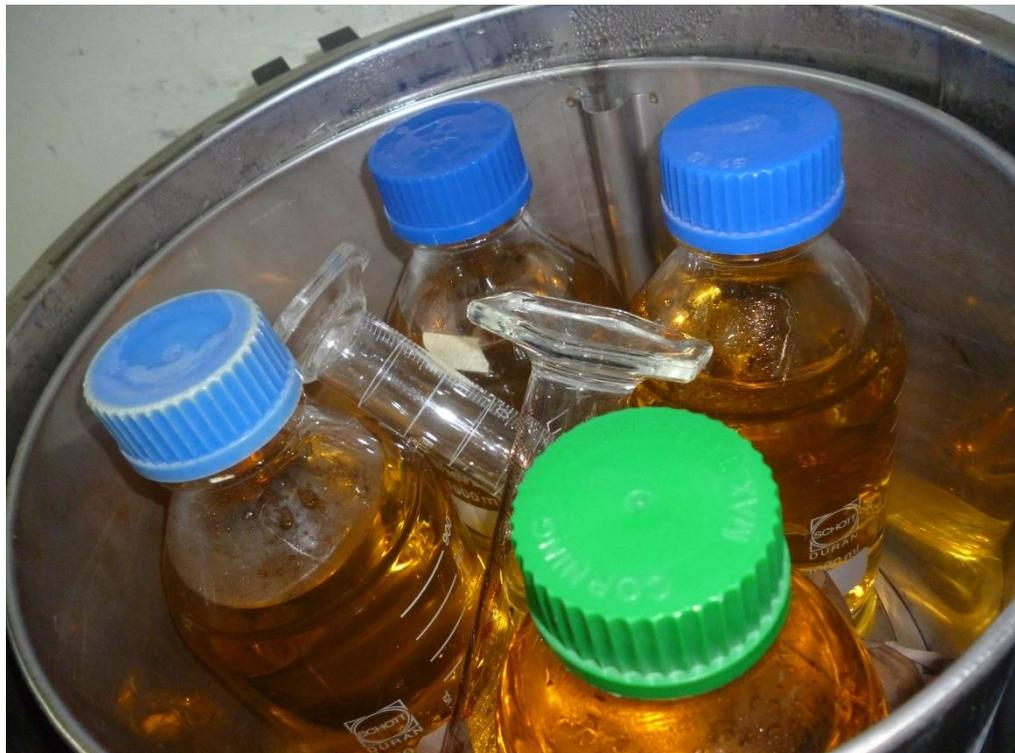
**Anexo 11. Disoluciones sacadas del Autoclave, enfriando.**
