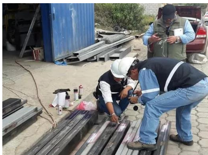
Figura 20. Inspección por líquidos penetrantes.
