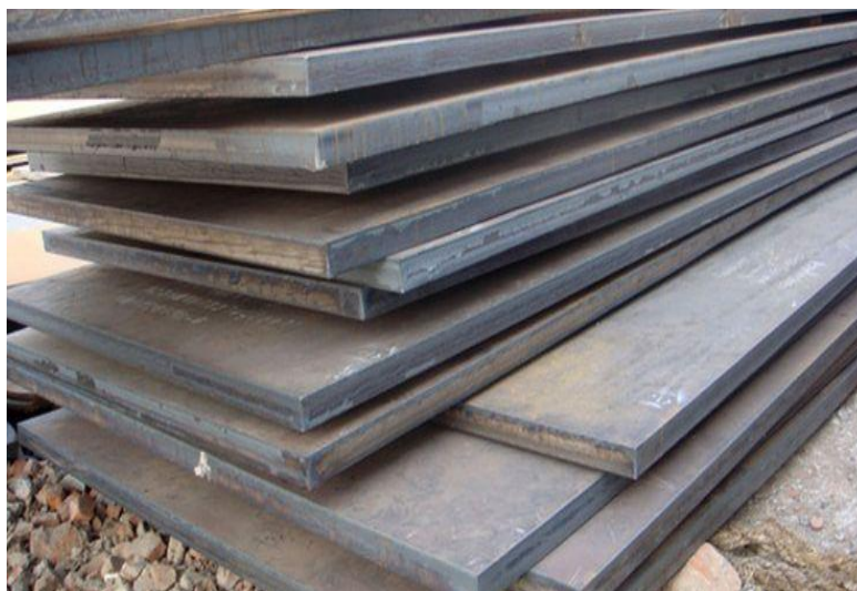
Figura 3. Planchas de acero al carbono.
