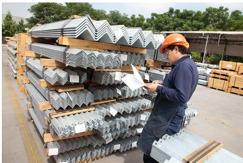
Figura 18. Inspección visual de materiales de suministro.
