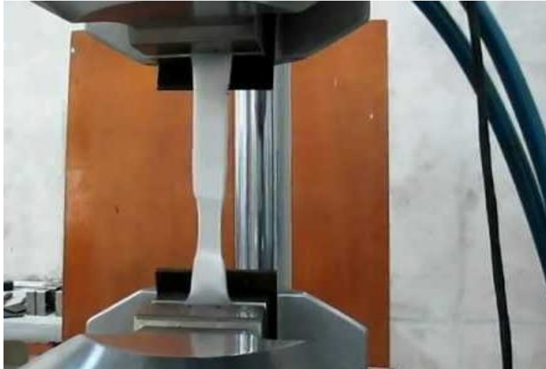
Figura 5. Ensayo de tensión aplicado a planchas de acero.
