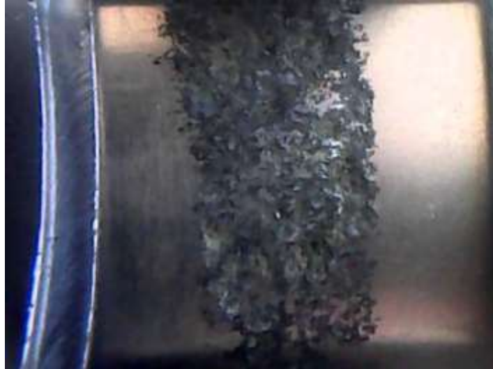
Figura 4 Corrosión por picadura.
