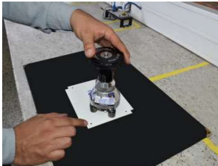
Figura 14 Ensayo de adherencia por tracción.
