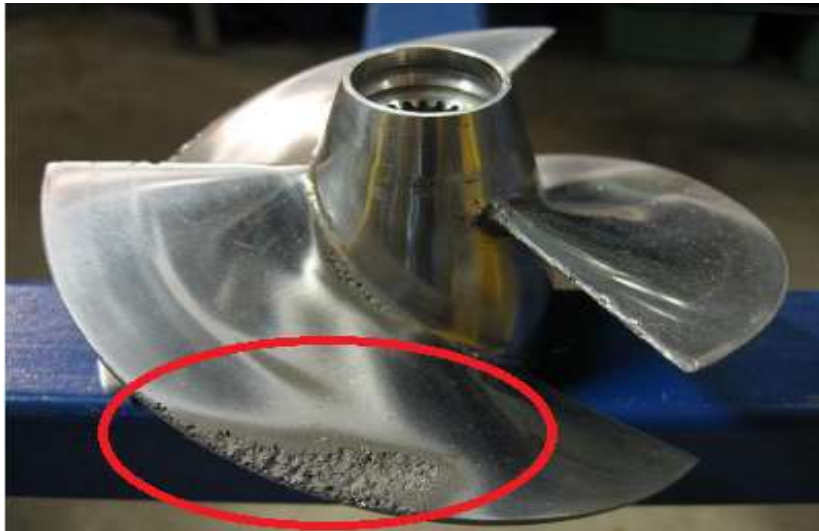
Figura 5 Corrosión por cavitación.
