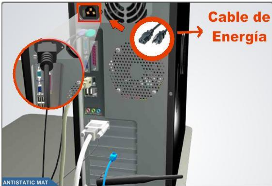
Figura 30: Conexión del cable que alimenta de energía a la fuente
