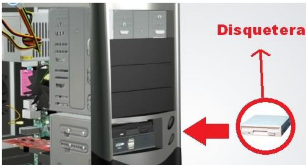
Figura 15: Instalación de lectora de disquetes
