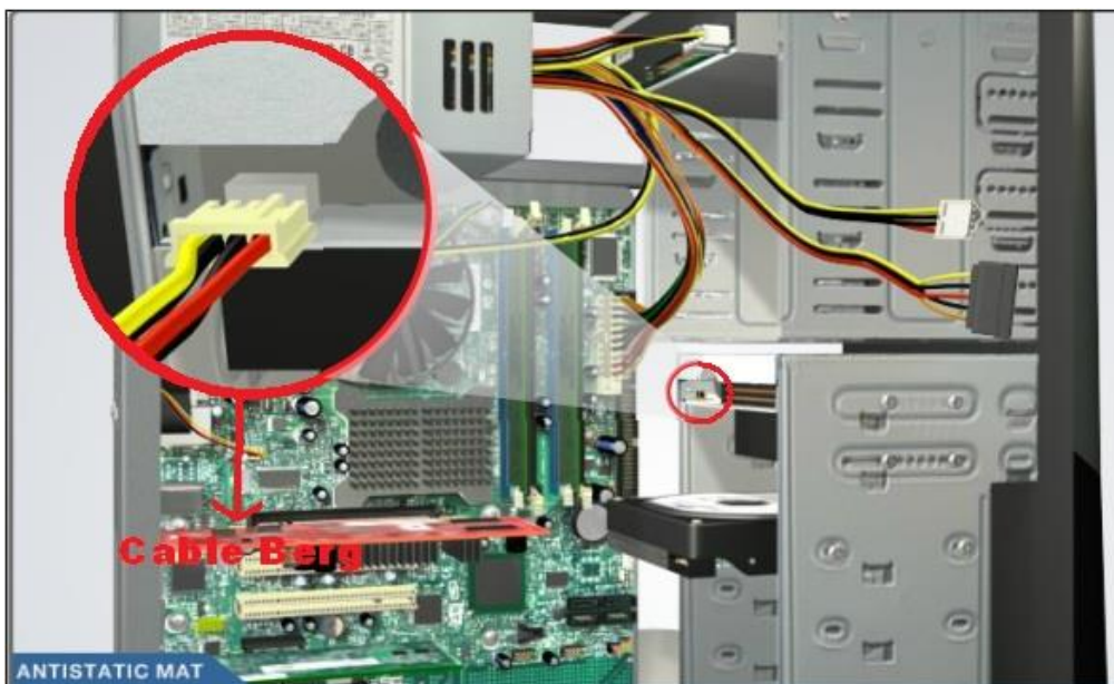
Figura 19: Conexión cable Berg
