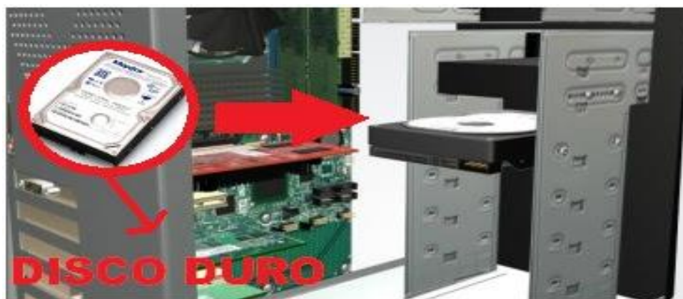
Figura 13: Instalación del disco duro
