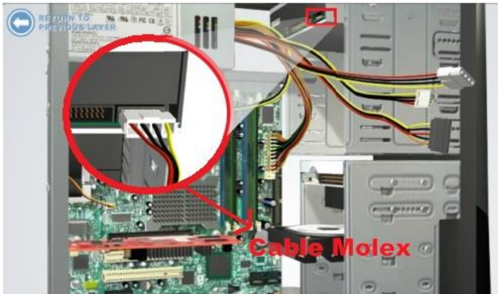
Figura 18: Conexión de las distintas unidades de entrada
