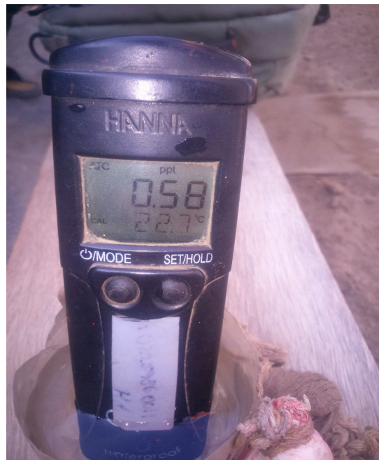
Figura 24. Medición de parámetros de agua subterránea.
