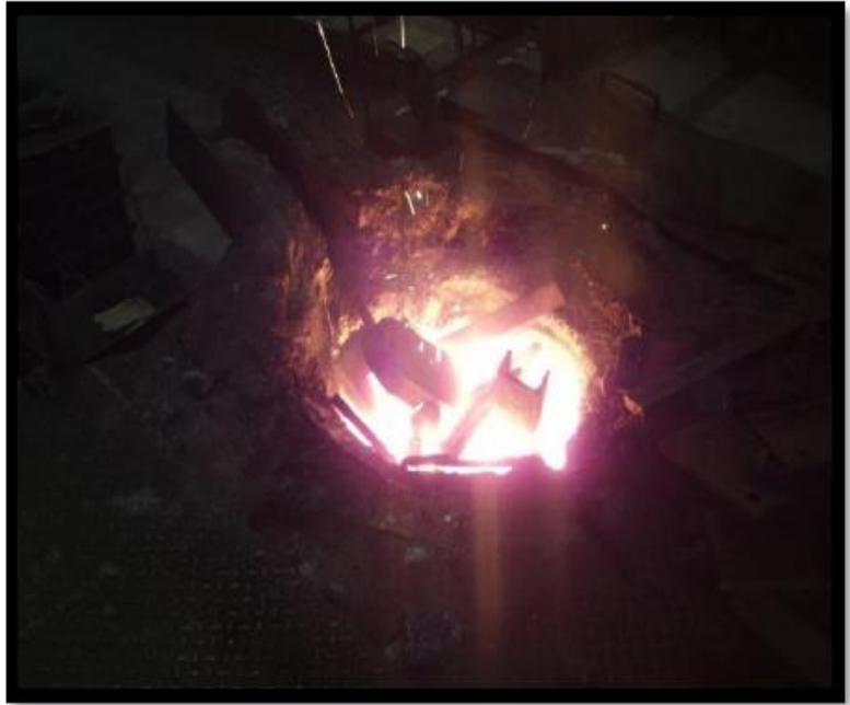
Figura 8: Carga de chatarra en un horno de inducción.
