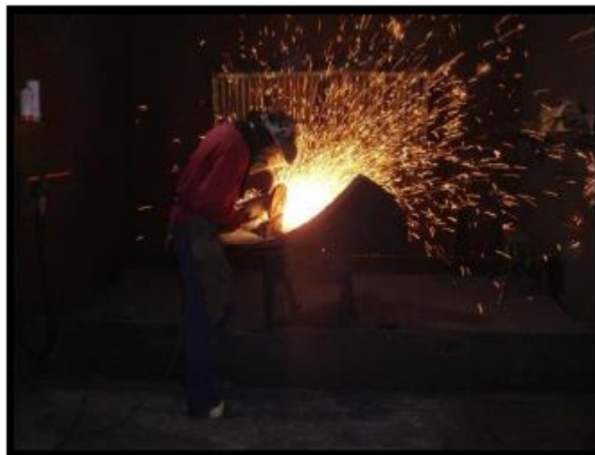
Figura 28: Desbarbado de una pieza.
