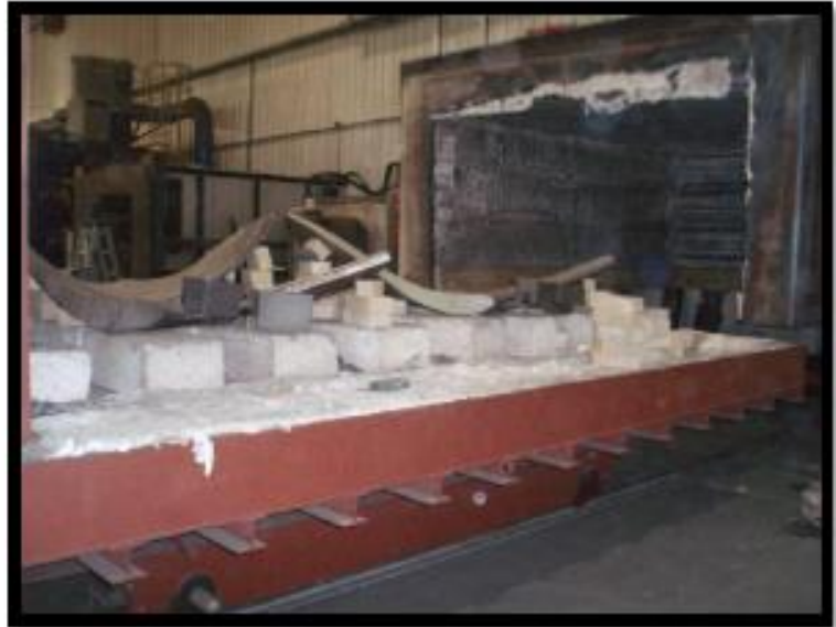
Figura 29: Horno de tratamiento térmico.
