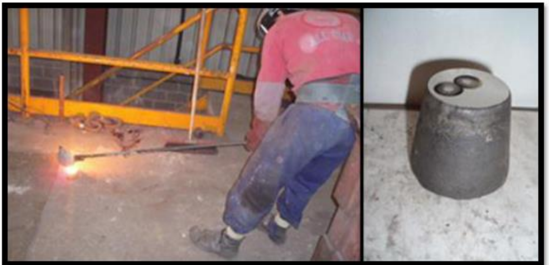
Figura 32: Toma de muestra de caldo y probeta analizada.
