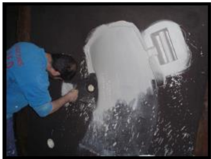
Figura 23: Pintado del molde una vez retirado el modelo.
