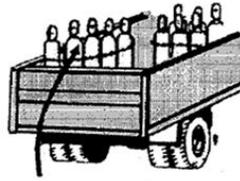
Los cilindros deben transportarse en forma vertical.
