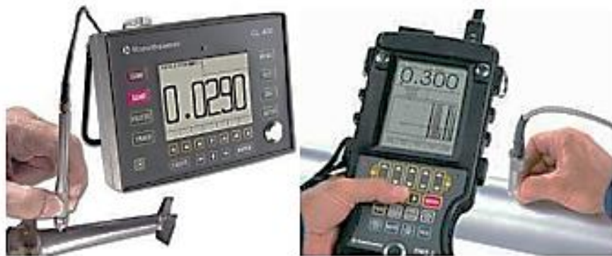
Figura 3.3. Medidor de espesores avanzado con barrido “A”
