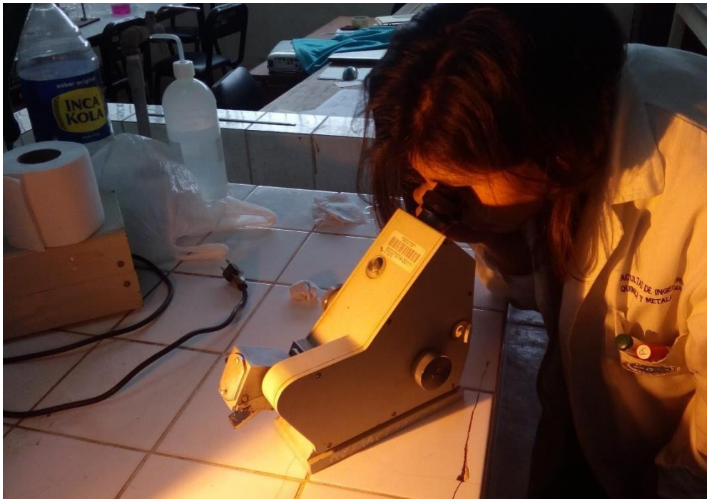
Figura 24. Determinación índice de refracción del jugo de manzana delicia
