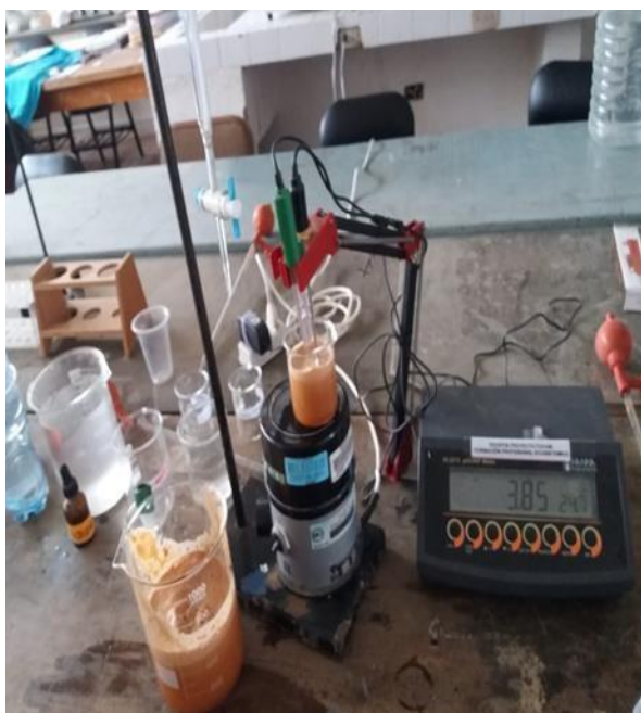
Figura 22. Valoración potenciométrica del mosto de manzana delicia
