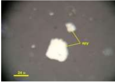
Fot. 1. Partículas libres de arsenopirita (apy). 500X.
