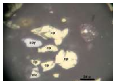
Fot. 6. Partículas libres de calcopirita (cp), de marcasita (mc) y de arsenopirita (apy). 500X.
