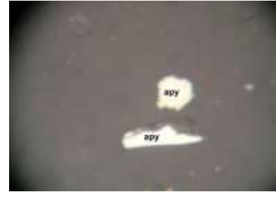
Fot. 3. Partículas libres de arsenopirita (apy). 500X.
