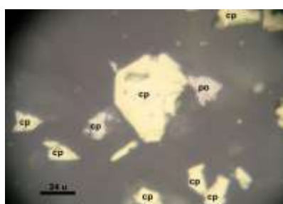
Fot. 1. Partículas libres de calcopirita (cp) y de pirrotita (po). 500X.
