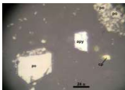
Fot. 4. Partículas libres de pirrotita (po), de calcopirita (cp) y de arsenopirita (apy). 500X.
