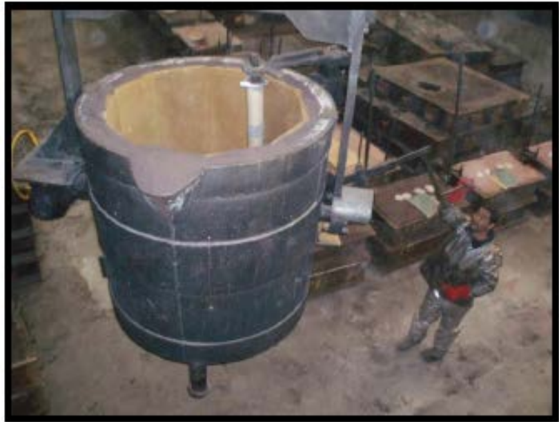
Figura 14: Cuchara de fundición.
