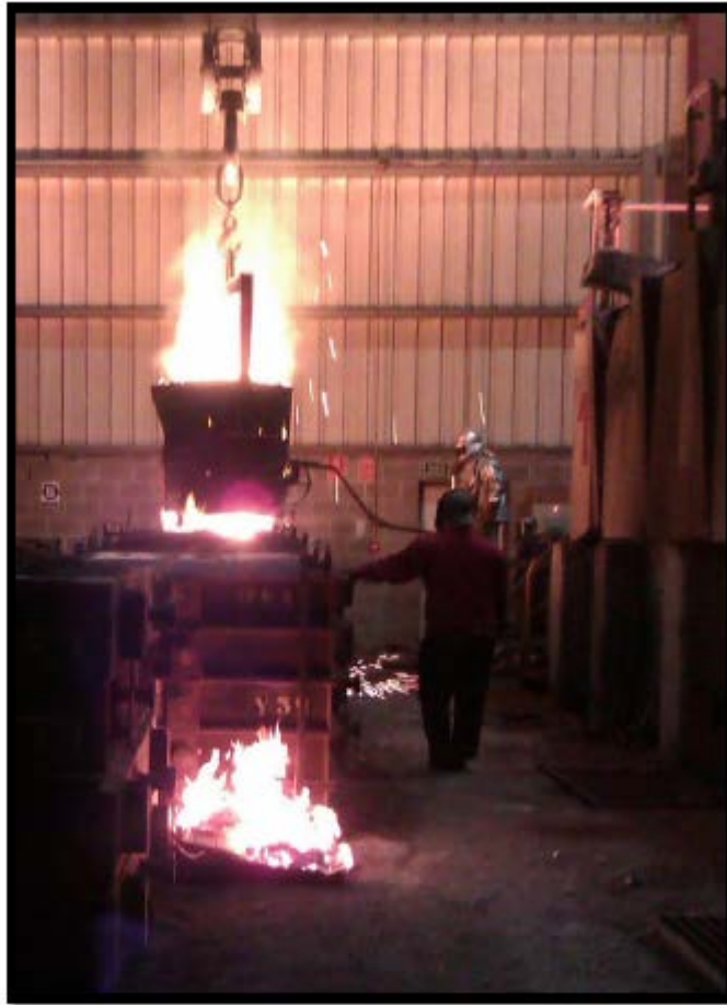
Figura 15: Traspase de la cuchara al molde de arena.
