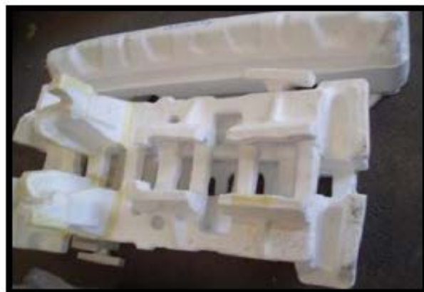
Figura 17: Esquema del proceso a la espuma perdida.
