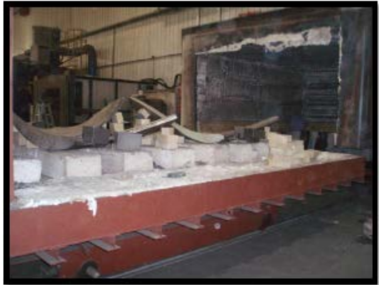
Figura 29: Horno de tratamiento térmico.
