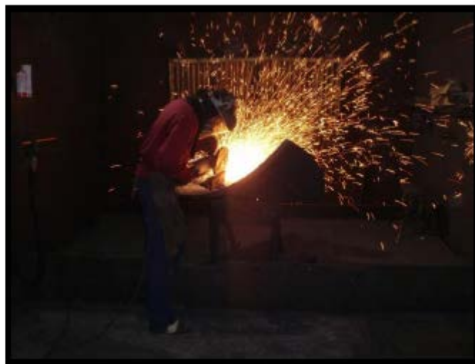
Figura 28: Desbarbado de una pieza.
