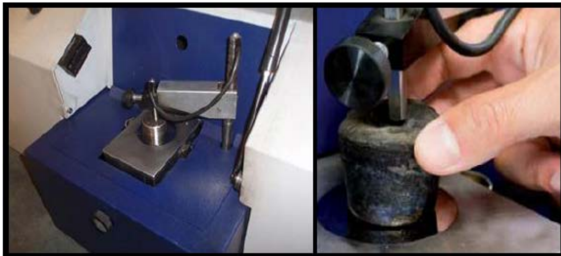
Figura 33: Espectrómetro de chispa o arco.
