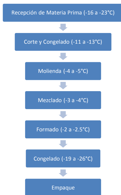
Figura N° 03: Diagrama de Bloques del Proceso de las Hamburguesas A y B
