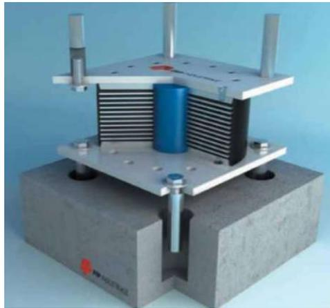
**Figura 32:** Aislador Elastomérico de Caucho con núcleo de plomo (LRB) “
