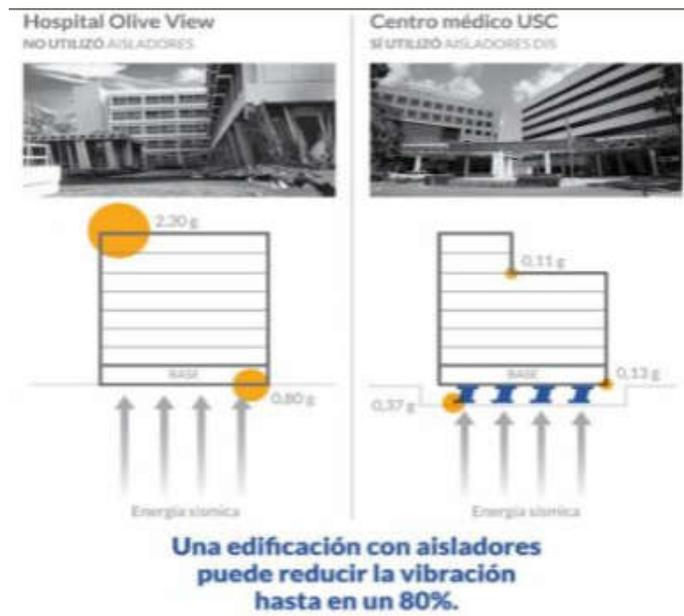
**Figura 35:** Comparación entre estructura empotrada en la base y estructura aislada
