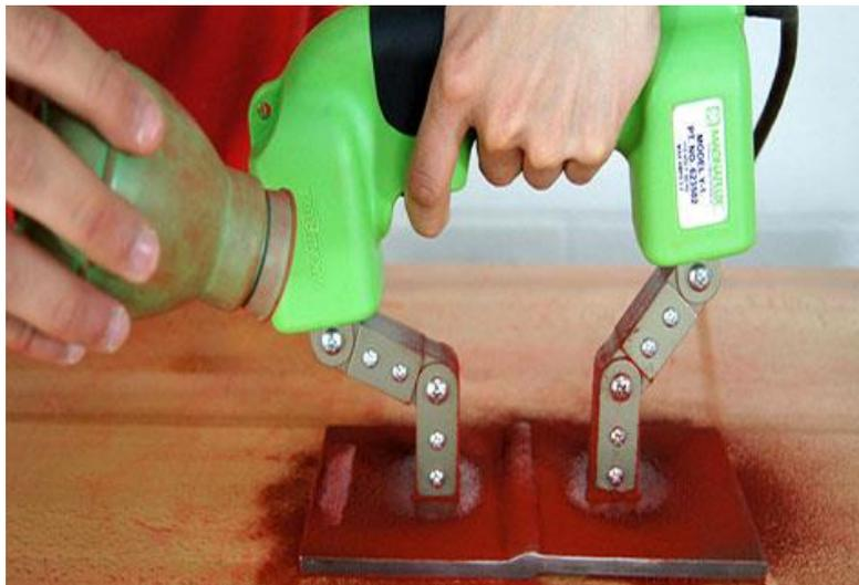
*Figura 4.* Ensayo por partículas magnéticas.
