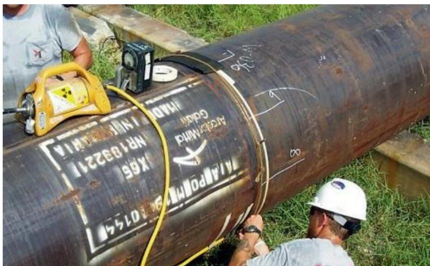
*Figura 6.* Ensayo por radiografía industrial.
