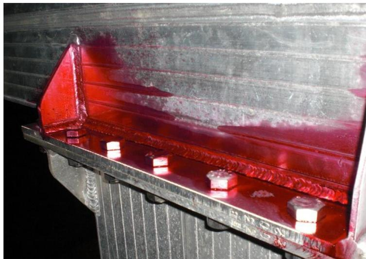
*Figura 3. Aplicación de líquido penetrante.*
