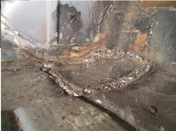
Presencia de fisura en la junta J6, presencia de acumulación de discontinuidades en la junta J7, ambas son rechazada de acuerdo a los criterios de aceptación de inspección visual – Tabla 6.1 AWS D1.1/D1.1M: 2015.
