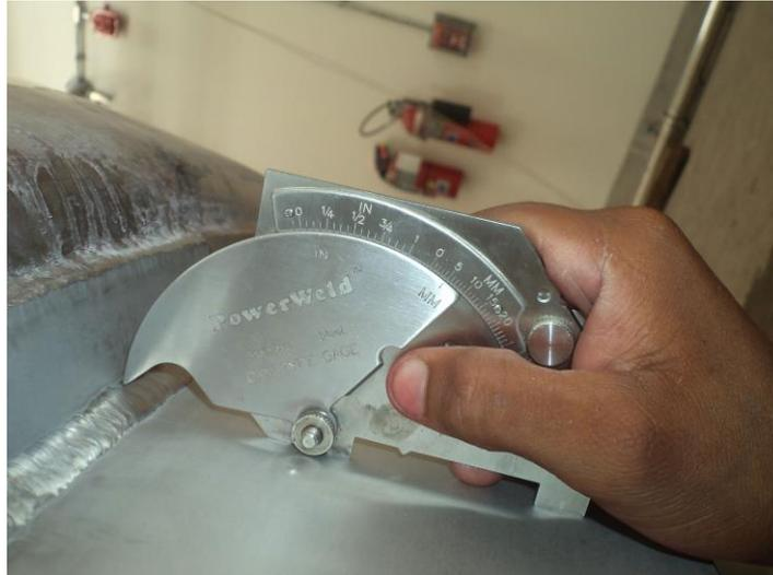
*Figura 2.* Aplicación de la inspección visual.
