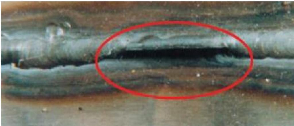
*Figura 12.* Penetración incompleta de junta.
