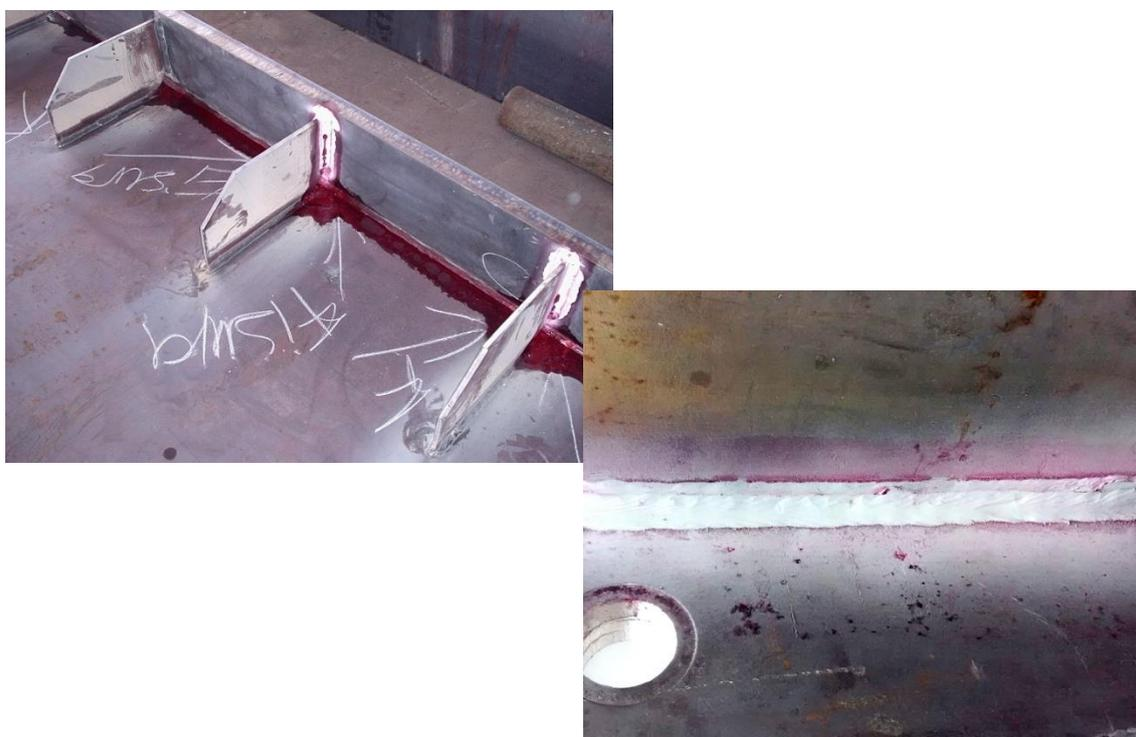
Presencia de fisura en la junta J15, J16 y J17, son rechazada de acuerdo a los criterios de aceptación de inspección visual – Tabla 6.1 AWS D1.1/D1.1M: 2015.
