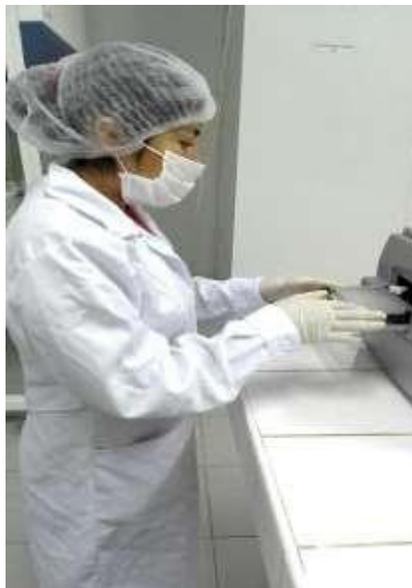
**Fig. 17.** Hacer la lectura en el equipo para su determinación de polifenoles totales en mg de ácido gálico/L de vino, mediante la absorbancia a una longitud de onda de 760 nm por espectrofotometría.
