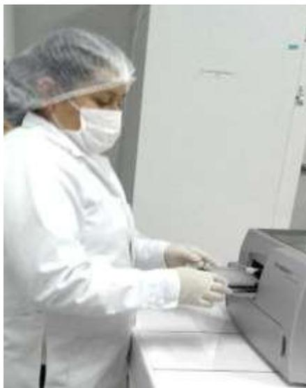
**Fig. 42.** Colocar la microplaca al equipo para su lectura a una longitud de onda de 520 nm, los resultados fueron expresados como capacidad antioxidante en mME Trolox/L
