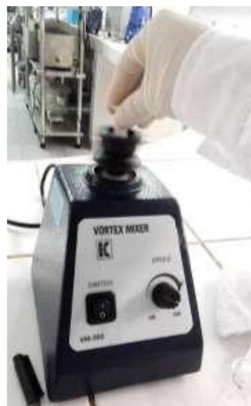
**Fig. 8.** Sistema homogeneizador
