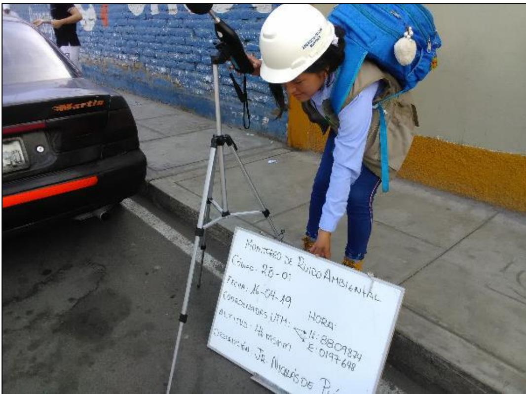
Figura 28. Realizando la medición de ruido en el perímetro del Hospital de Barranca. Autoría propia.
