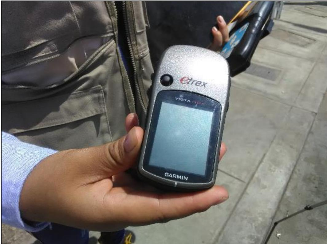
Figura 31. GPS utilizado para la ubicación de las coordenadas de cada punto de muestreo. Autoría propia.
