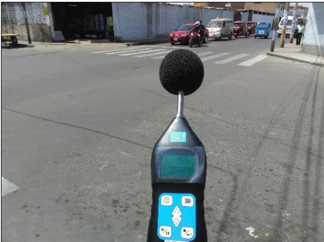
Figura 32. Sonómetro utilizado para la medición de los niveles de presión sonora. Autoría propia.
