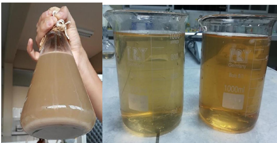
Foto 5: Comparación Efluente de Remojo antes (izquierda) y después del tratamiento día 12 (derecha) a 5100 Lx y 7.2 de pH
