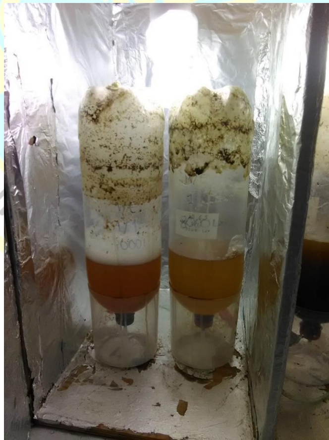
Foto 4: Fotobiorreactor a 8100 Lx al 10 día, se aprecia la fotoinhibición.
