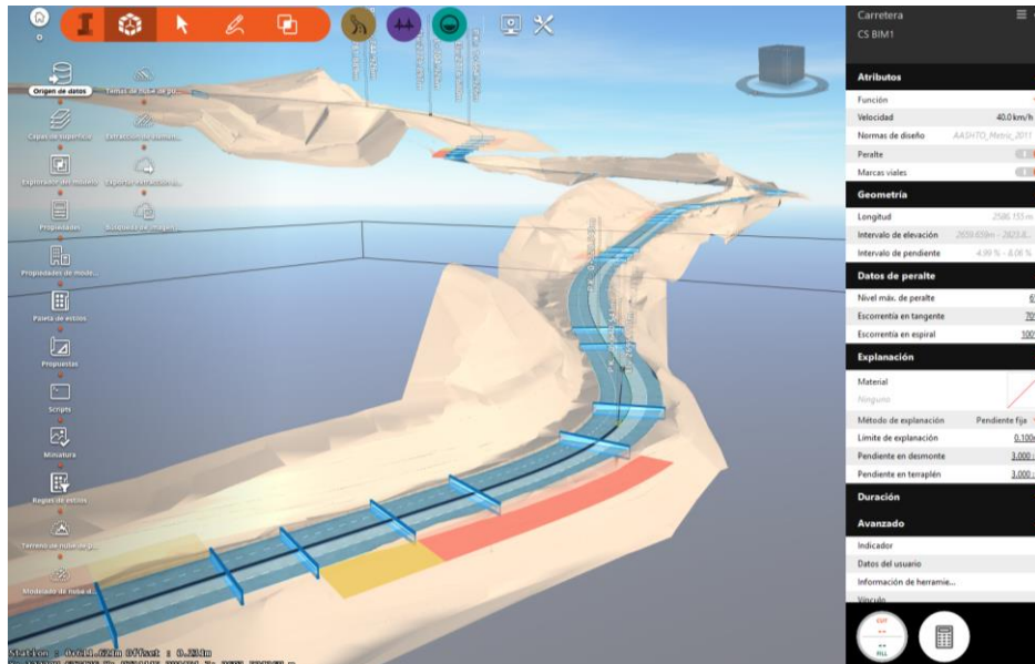
Figura 46 vista de peraltes Fuente (Propia) Se podrá verificar la superficie de rodadura
