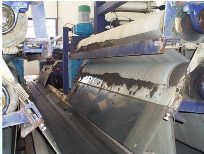
Ilustración 58: Filtro banda. Imagen tomada de: http://1.bp.blogspot.com/adKAtLWzKsU/T_Ilx6pe25I/AAAAAAAAAPE/3l06iJrWgy0/s1600/Sin+t%25C3%25ADulo.png
