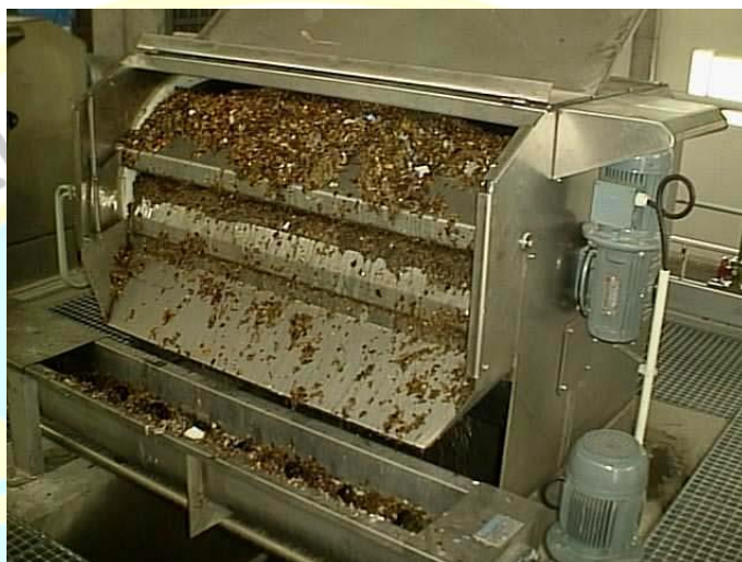
Ilustración 23: Tamiz rotatorio. Imagen tomada de: http://www.aguamarket.com/sql/productos/fotos/TR%206100%20funcionando.jpg
