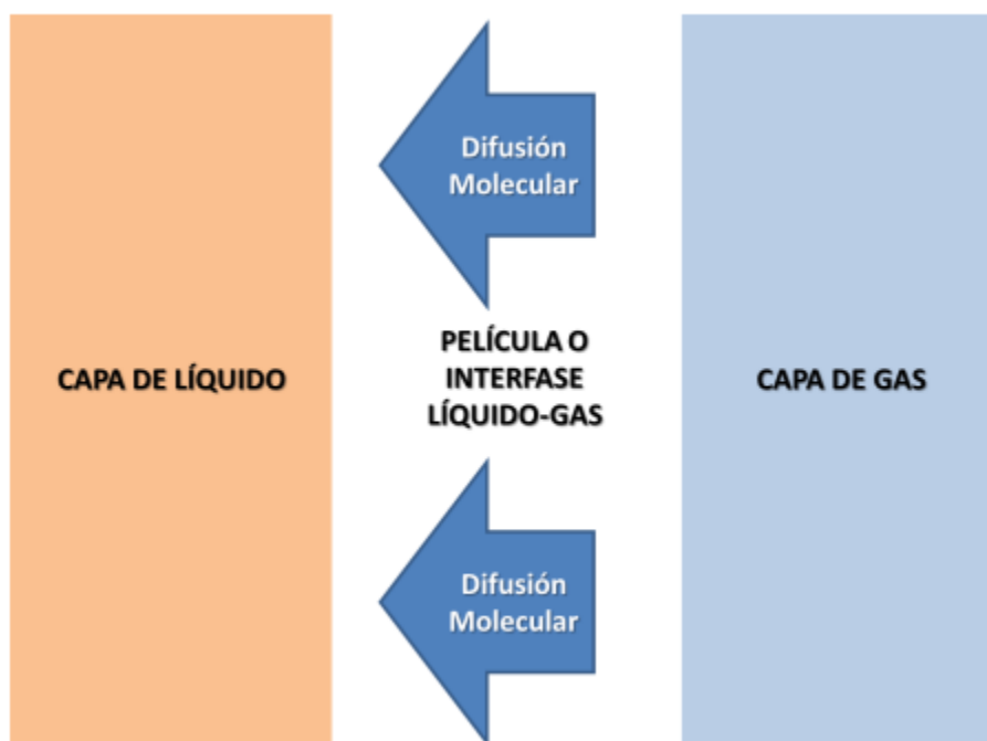
Ilustración 31: Teoría de la doble capa de difusión molecular gas-líquido. Lozano, (2012).
