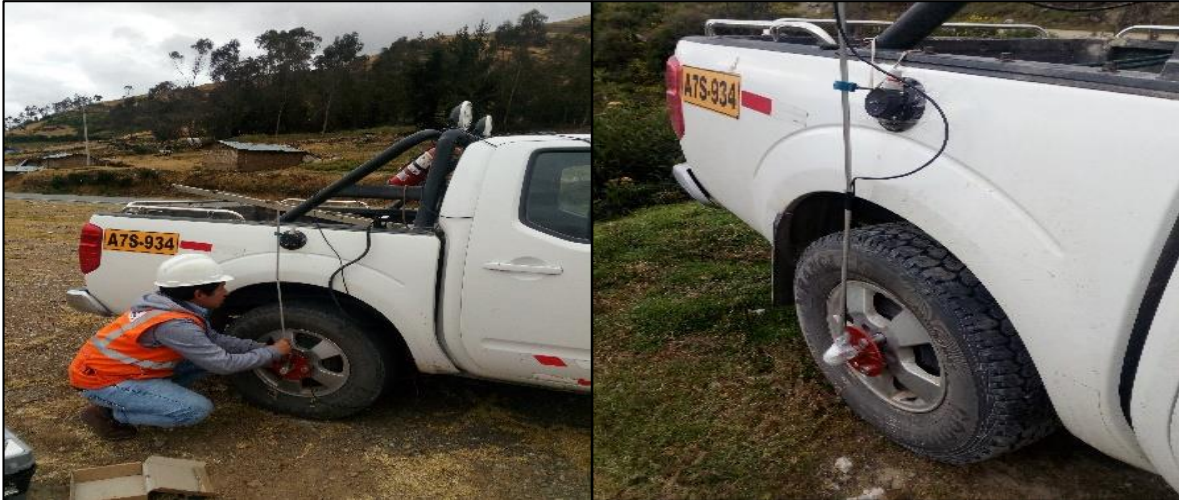
Figura 17- Instalación del Equipo DMI
