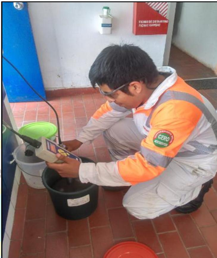
Fotografía N° 5 Determinando el SST de la muestra
