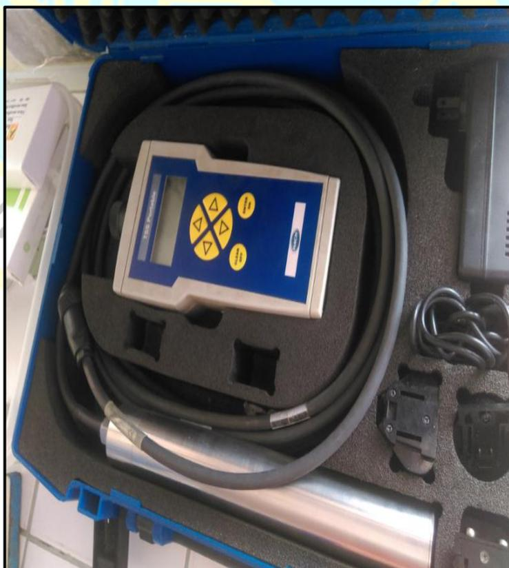
Fotografía N° 4 Equipo medidor de SST
