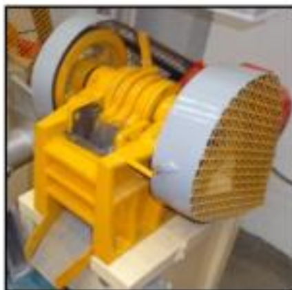
Figura 20: trituradora de quijada 2"x4"
