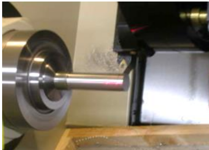
Figura 15. Preparación de probetas para tratamiento térmico.
