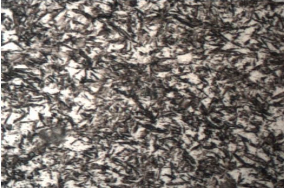
Figura 20. Microestructura del acero AISI M42 revenido a 250 °C.
