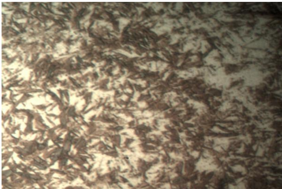
Figura 21. Microestructura del acero AISI M42 revenido a 450 °C.
