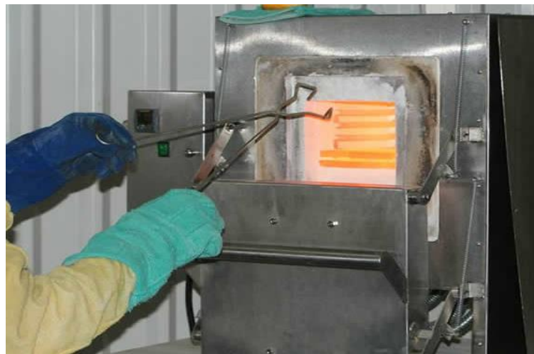
Figura 17. Horno de tratamiento térmico.
