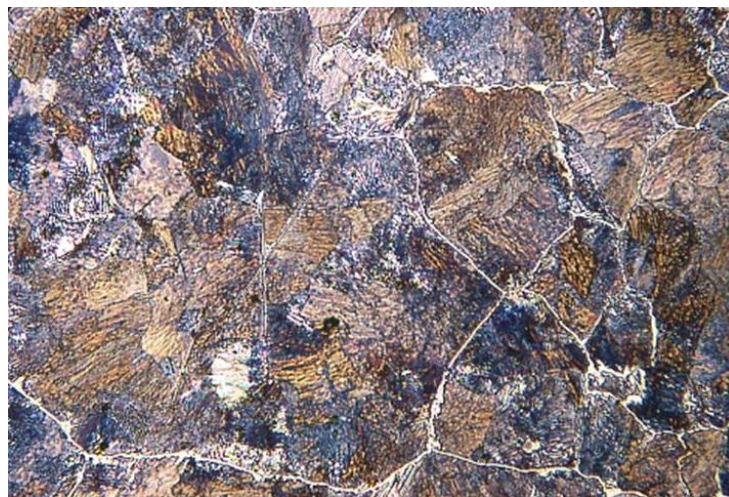
Figura 3. Microfotografía de austenita.
