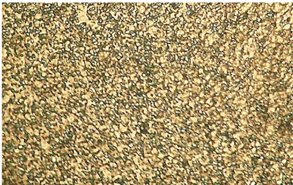
Figura 18. Microestructura del acero AISI M42 (Bonificado)
