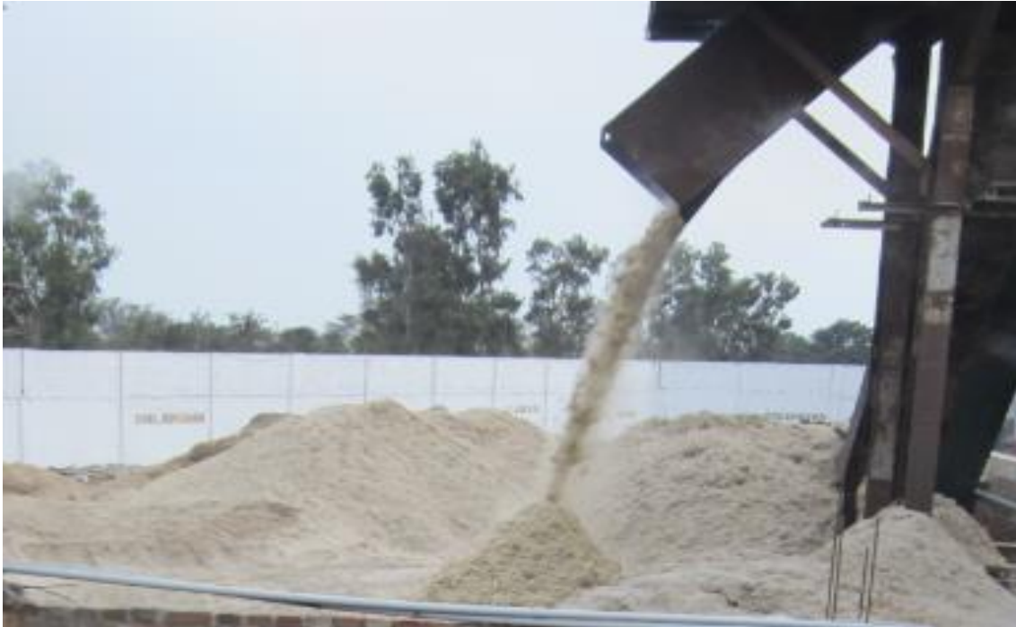
Figura 21. Almacenamiento de bagazo excedente
