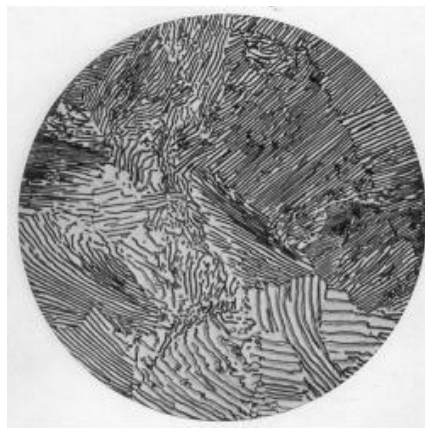
Figura 4. Micrografía a 1000x Fe + 0,8% C
