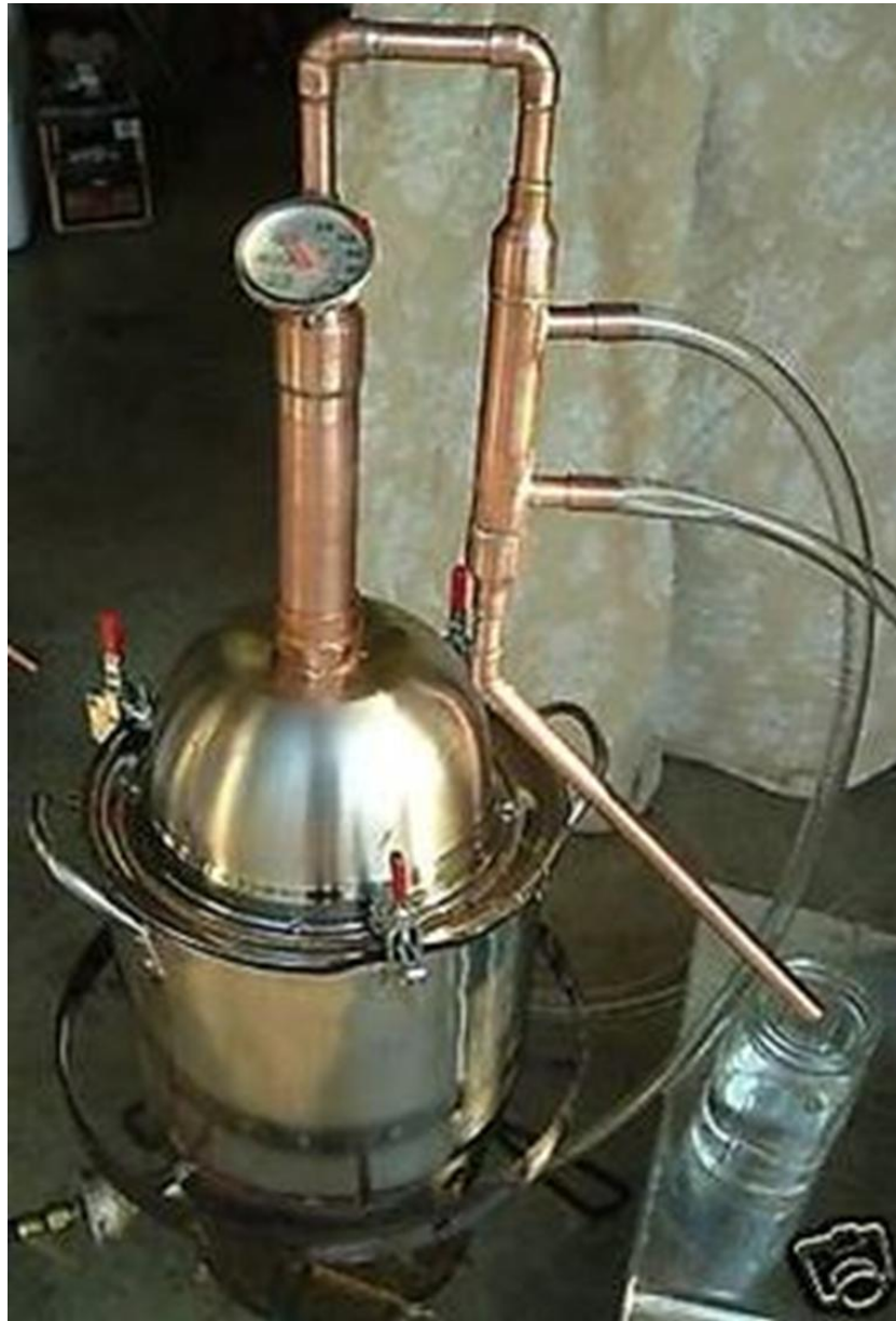
A2: Hidrodestilador con reflujo. El agua de refrigeración del refrigerante reingresa a la cámara de agua.
