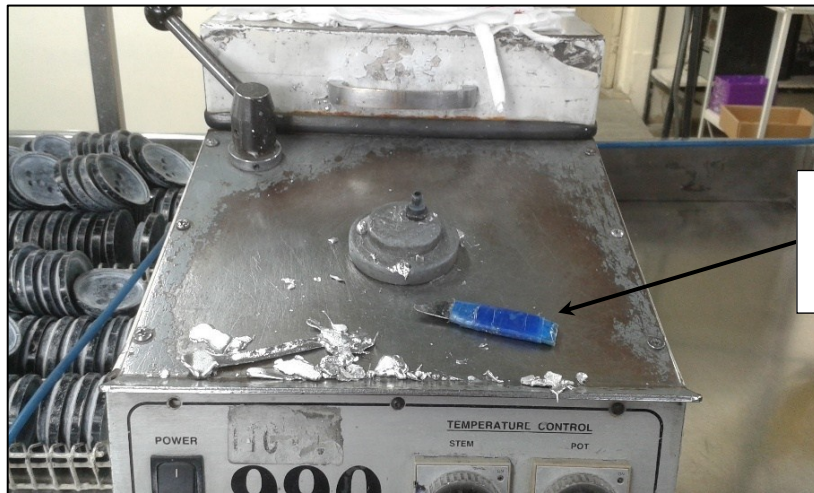
Figura 8. Herramienta no estándar en el proceso de tallado.
