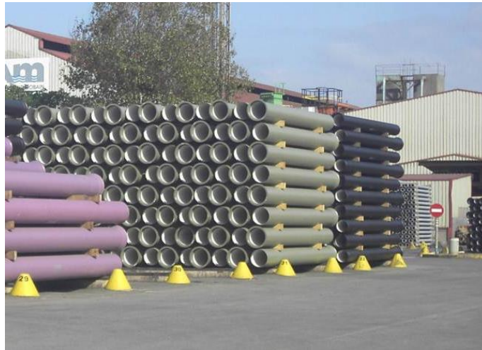
Figura 4. Tubería de hierro dúctil.
