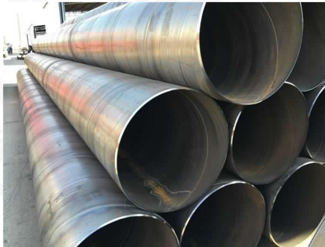
Figura 2. Tubería forzada de acero al carbono.
