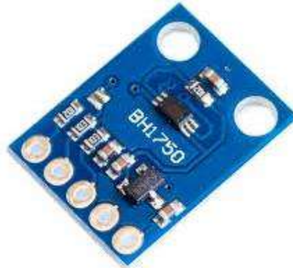
Figura 8. Sensor de intensidad lumínica BH1750
