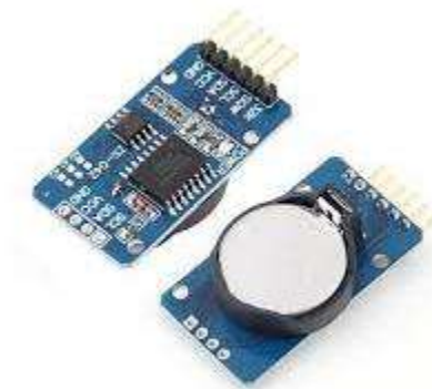
Figura 14. Módulo RTC DS3231
