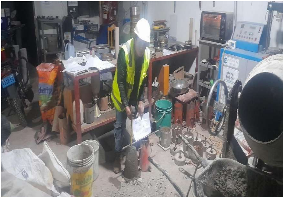
Foto 13. Prueba de asentamiento de mezcla con mineral hierro molido al 15% (cono de abrams).
