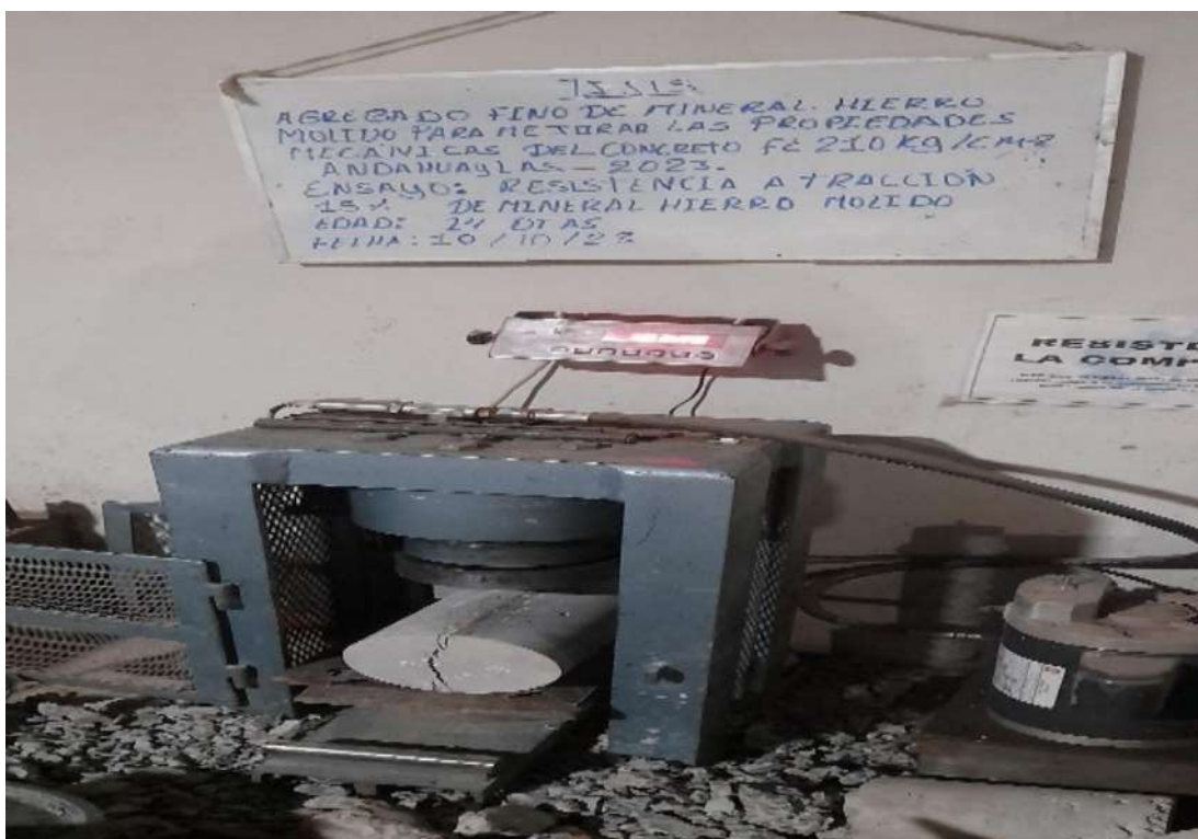
Foto 24. Rotura de briqueta por ensayo a tracción indirecta con 15% de mineral hierro molido.
