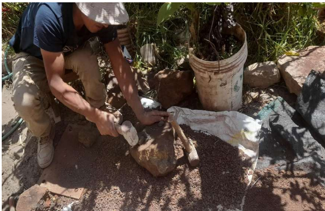
Foto 04. Mineral hierro al 95% de finalizar la trituración.
