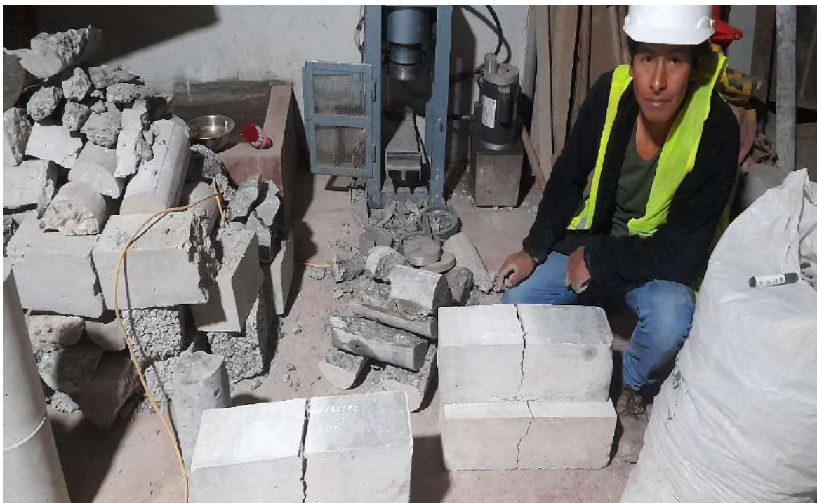
Foto 29. Tipo de falla en las vigas prismáticas con adición de mineral hierro molido.
