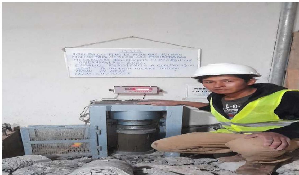
Foto 21. Rotura de briqueta por ensayo a compresión con 15% mineral hierro molido.
