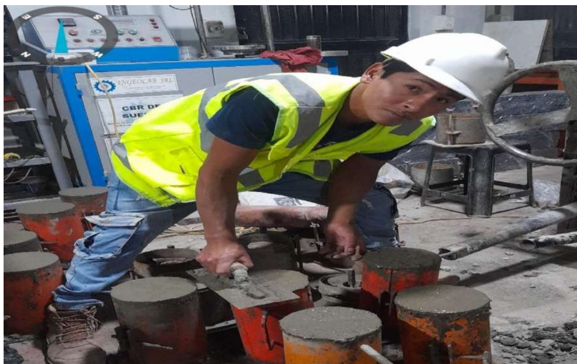
Foto 14. Llenado de mezcla patrón a briquetas con 0% de mineral hierro molido.
