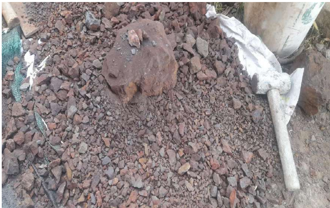
Foto 03. Mineral hierro en 70% de trituración.
