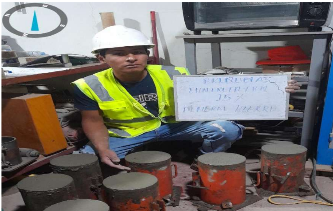
Foto 15. Llenado de mezcla a briquetas con 15% de mineral hierro molido.
