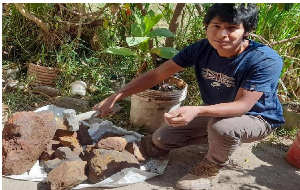
Foto 02. Mineral hierro libre de material orgánico listo para ser triturado.
