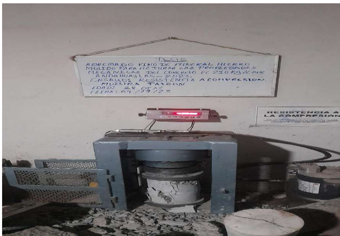
Foto 20. Rotura de briqueta patrón por ensayo a compresión con 0% mineral hierro molido
