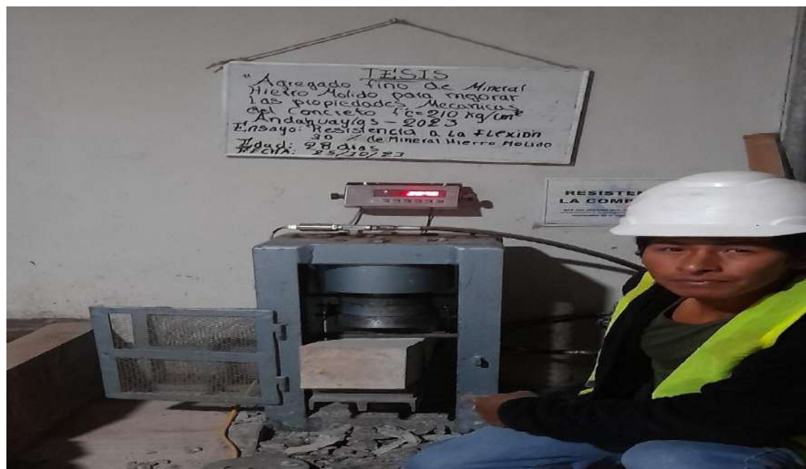
Foto 28. Rotura de vigas prismática con 30% de mineral hierro molido a los 28 días por ensayo a flexión.
