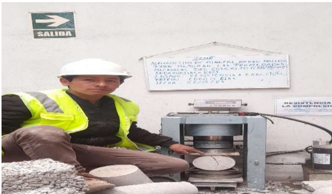
Foto 23. Rotura de briqueta patrón por ensayo a tracción indirecta con 0% de mineral hierro molido.
