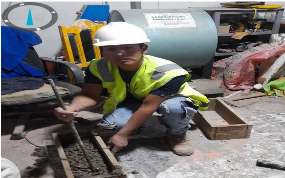
Foto 17. Llenado de mezcla a moldes prismáticos para el ensayo a flexión.
