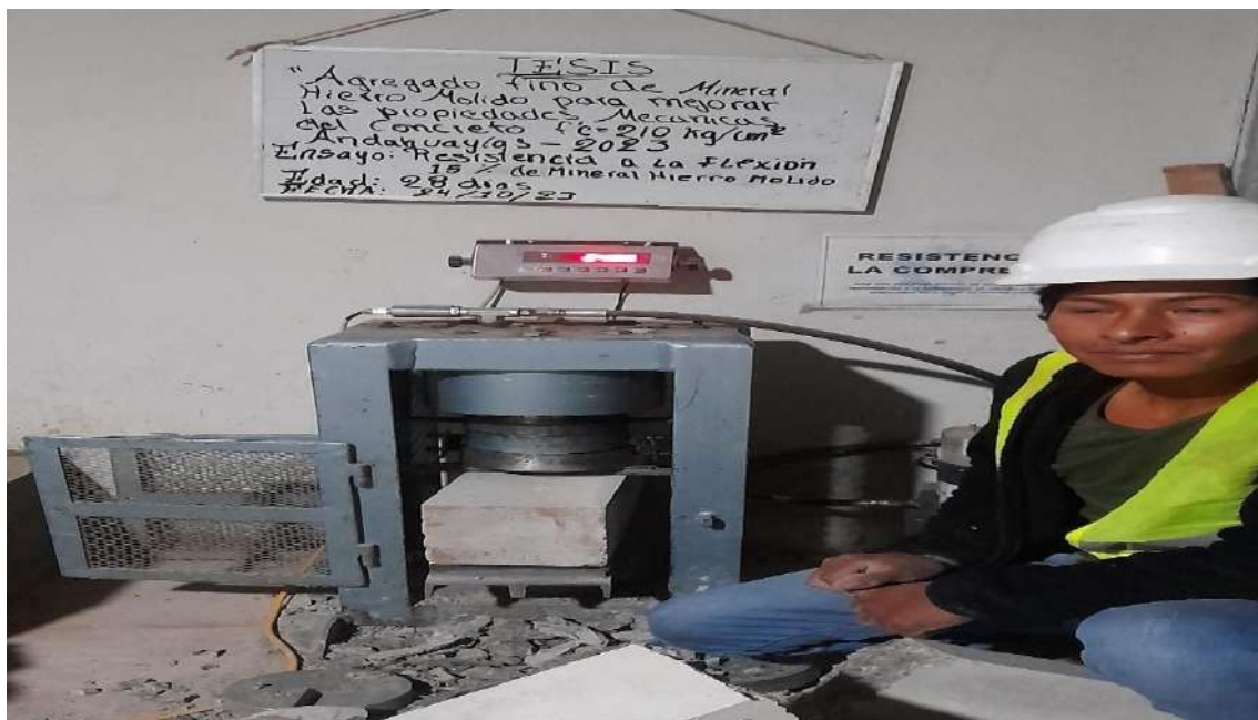
Foto 27. Rotura de vigas prismática con 15% de mineral hierro molido a los 28 días por ensayo a flexión.
