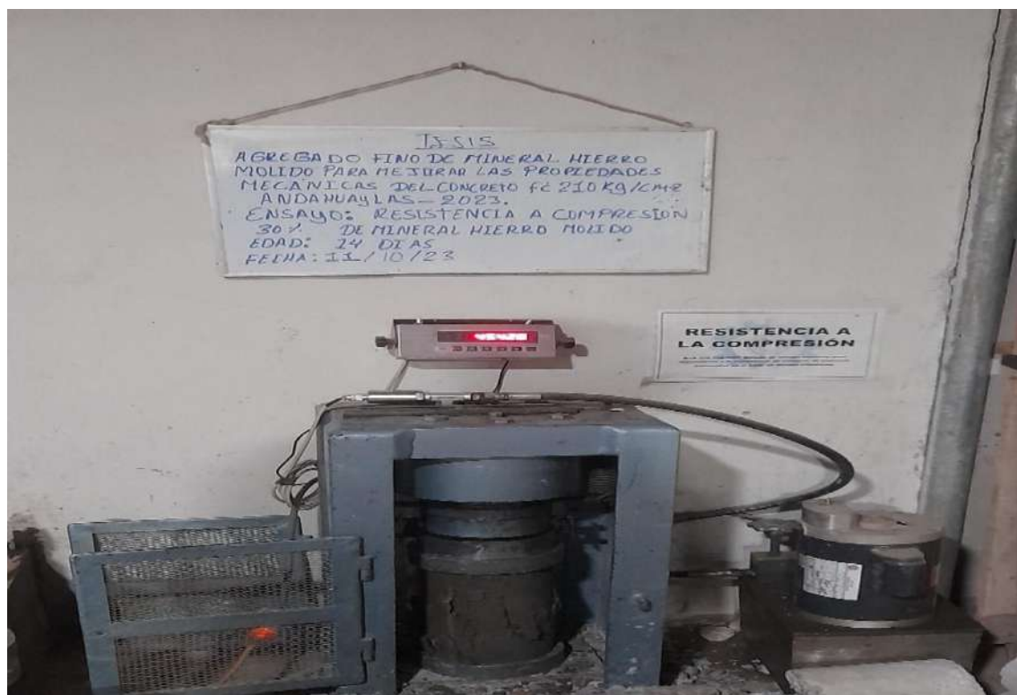
Foto 22. Rotura de briqueta por ensayo a compresión con 30% mineral hierro molido.
