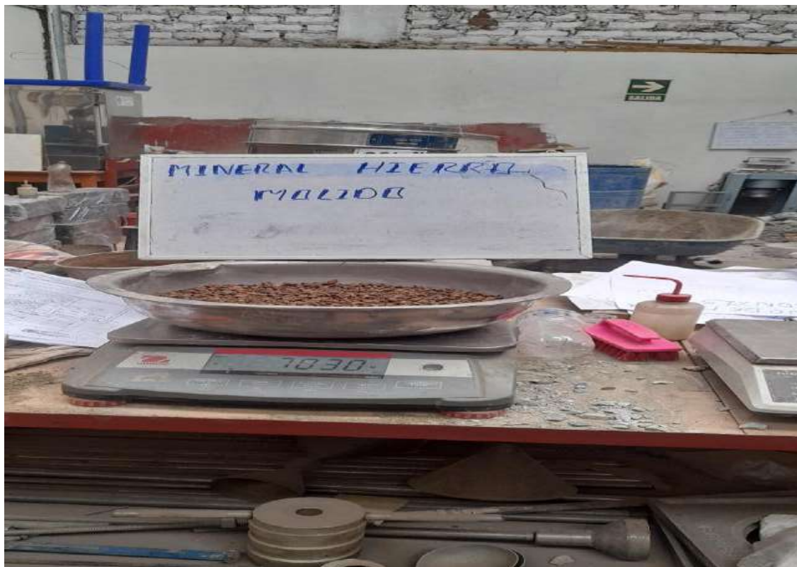
Foto 07. Pesado del Mineral Hierro molido.
