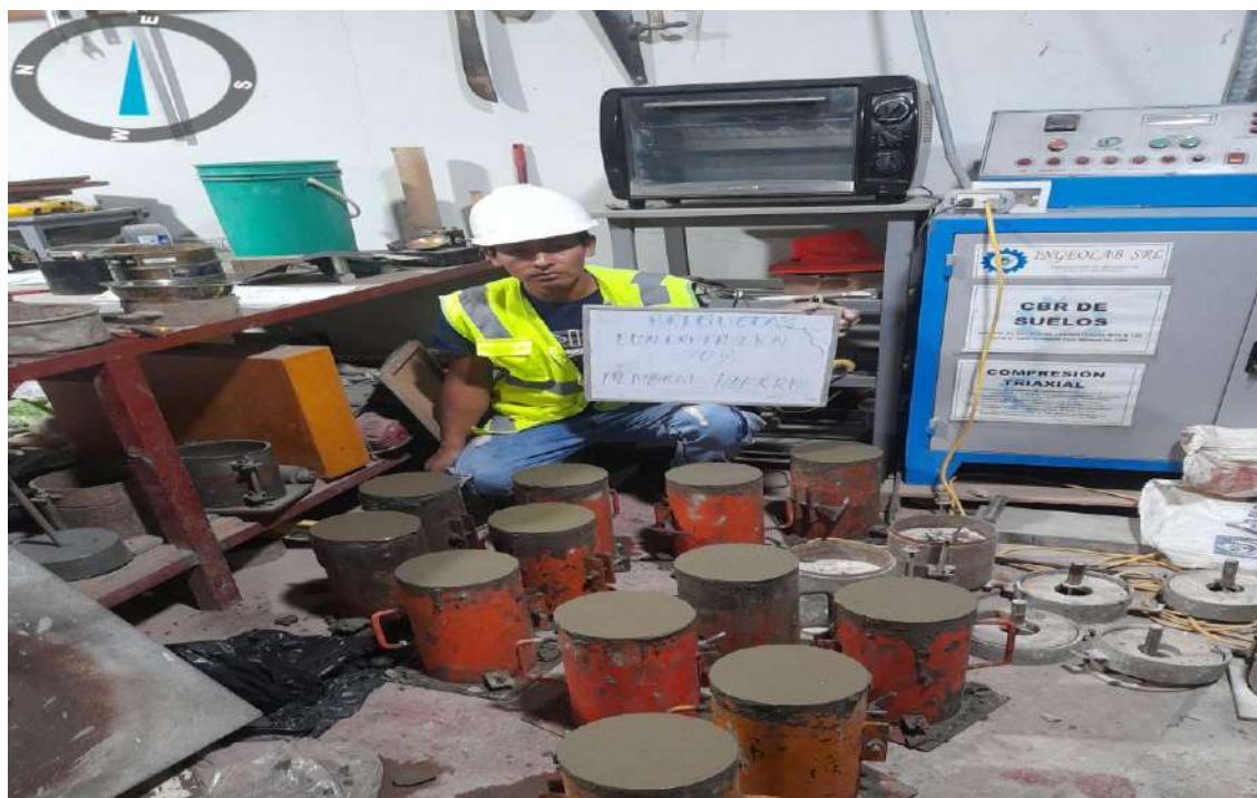
Foto 16. Llenado de mezcla a briquetas con 30% de mineral hierro molido.
