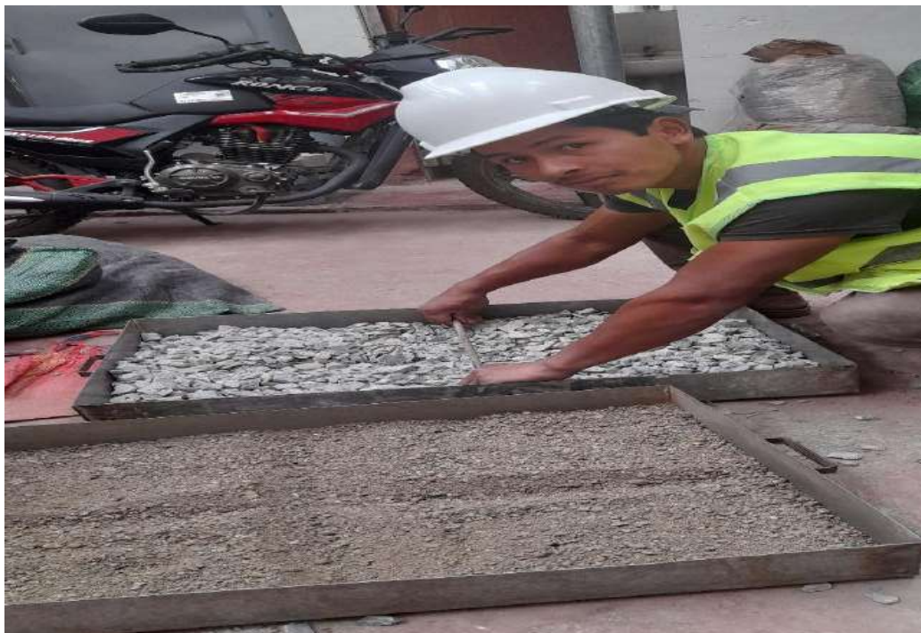
Foto 05. Selección de material por el método de Cuarteo del agregado fino, grueso para los siguientes ensayos.
