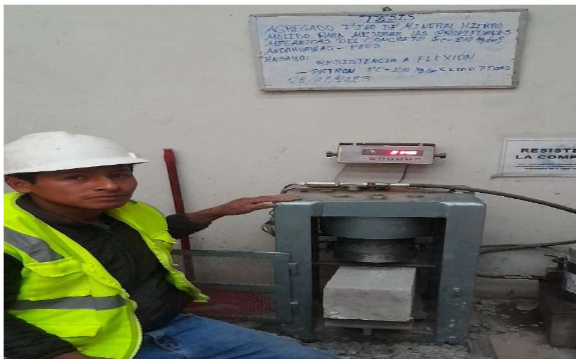
Foto 26. Rotura de vigas prismática patrón los 28 días por ensayo a flexión.
