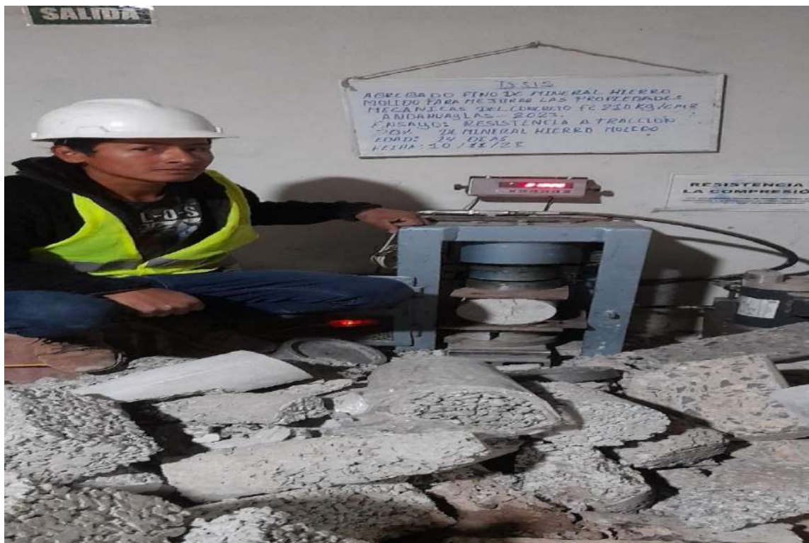
Foto 25. Rotura de briqueta por ensayo a tracción indirecta con 30% de mineral hierro molido.
